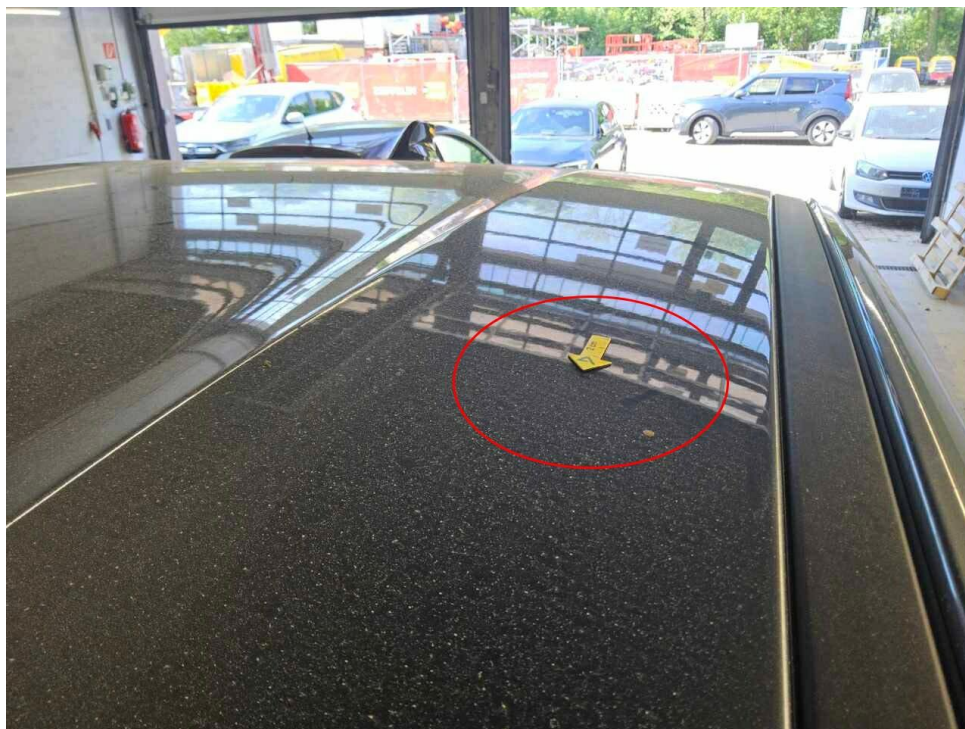
Bild 16 : Dach, eingedellt, drücken
