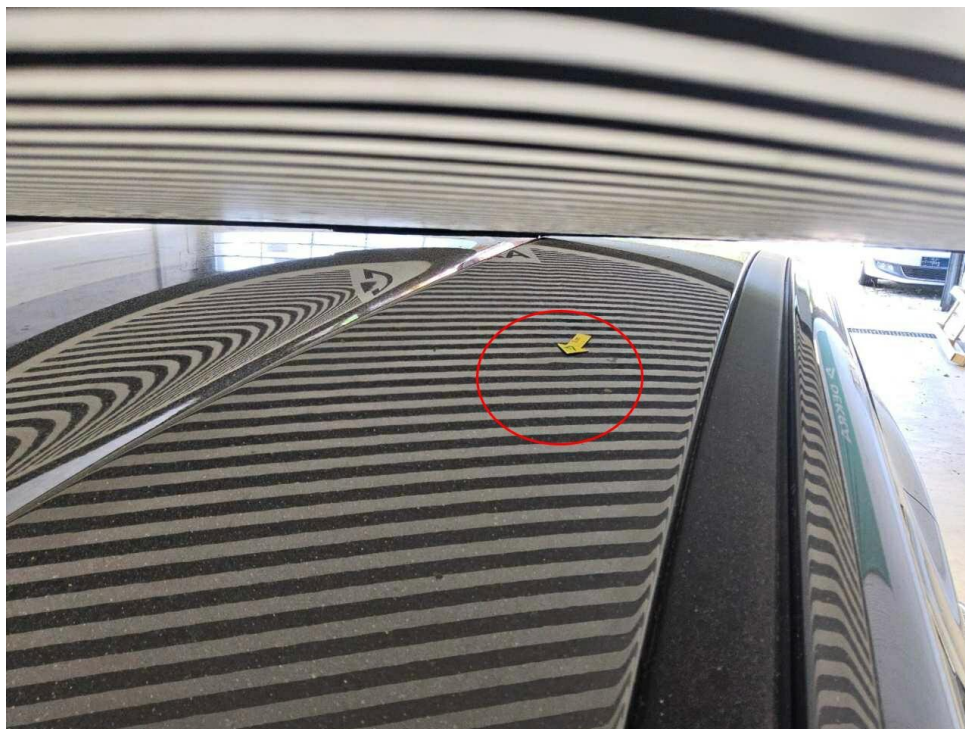
Bild 18 : Dach, eingedellt, drücken
