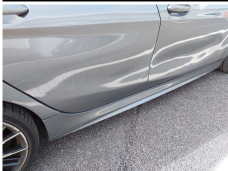
Revêtement de bas de caisse / Droit / Rayure
