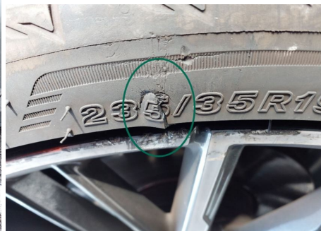
Pneu / Avant Gauche / Déchiré
