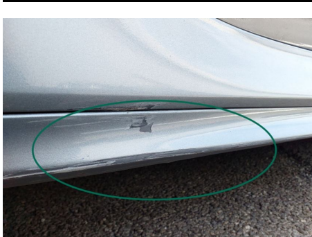
Revêtement de bas de caisse / Droit / Rayure
