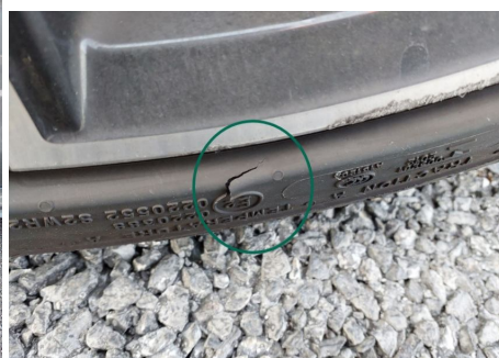
Pneu / Arrière Droit / Déchiré
