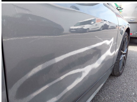
Porte / Avant Droit / Malfaçon
