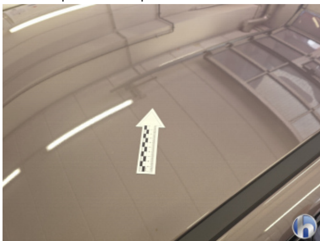
2. Dach 1 Delle - Sanft Instandsetzen
