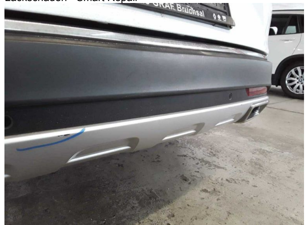
Beschädigung #10: Stossfänger hinten: Spoiler - verkratzt / verschürft - Smart Repair
