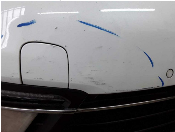
Beschädigung #11: Stossfänger vorn: Stossfänger vorn - verkratzt / verschürft - Smart Repair
