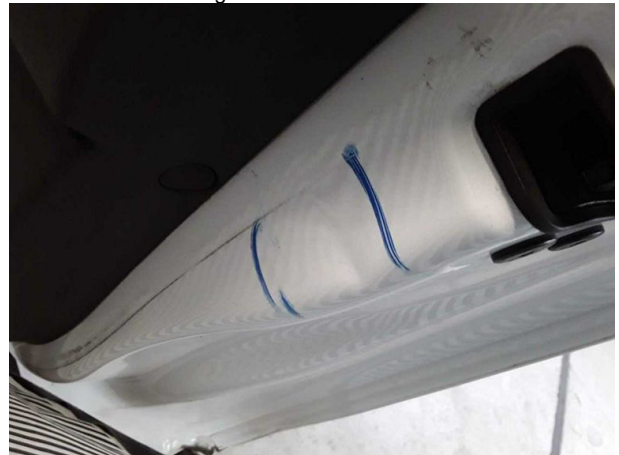
Beschädigung #2: Tür vorn rechts: Tür - Delle(n) - sanft instandsetzen
