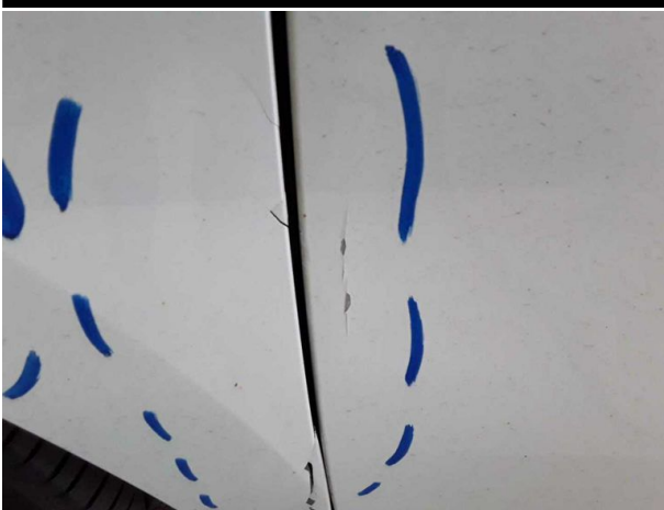
Beschädigung #14: Tür vorn links: Tür - Delle / Lackschaden - instandsetzen und lackieren
