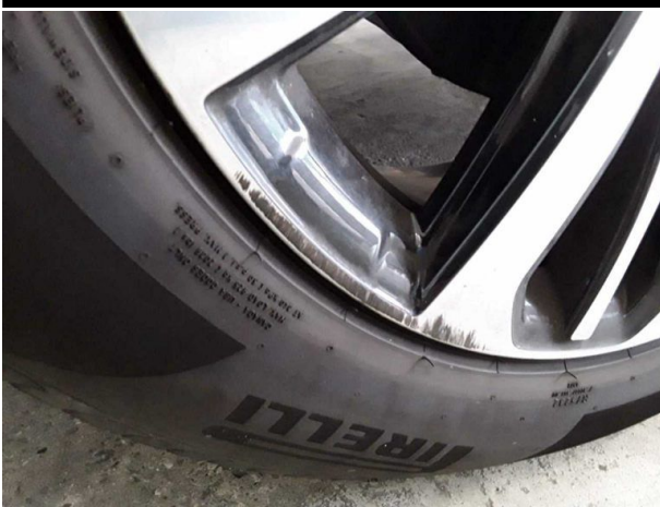
Beschädigung #7: Rad/Reifen: Leichtmetallfelge vorn links - verkratzt / verschürft - Wertminderung
