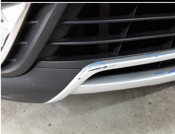
Beschädigung #12: Stossfänger vorn: Spoiler - verkratzt / verschürft - instandsetzen und lackieren
