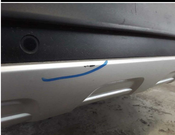
Beschädigung #10: Stossfänger hinten: Spoiler - verkratzt / verschürft - Smart Repair
