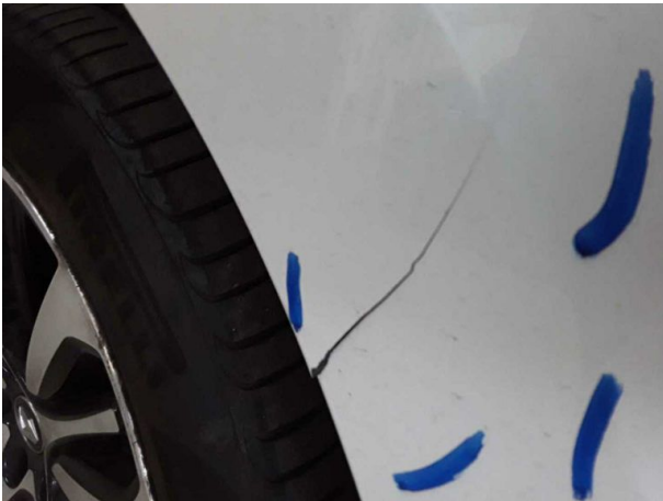
Beschädigung #15: Kotflügel links: Kotflügel links - gebrochen / gerissen - erneuern
