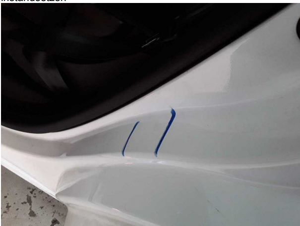
Beschädigung #3: Seitenwand links: Einstieg - Delle(n) - sanft instandsetzen
