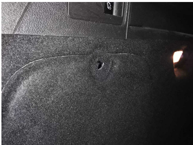
Damage 1: Trim / covers: Boot lining (Auf beiden Seiten fehlt die Verriegelung) - Damaged - Replace
