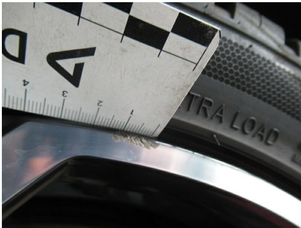
Bild 17 : Felge vorne rechts, zerkratzt, Gebrauchsspur
