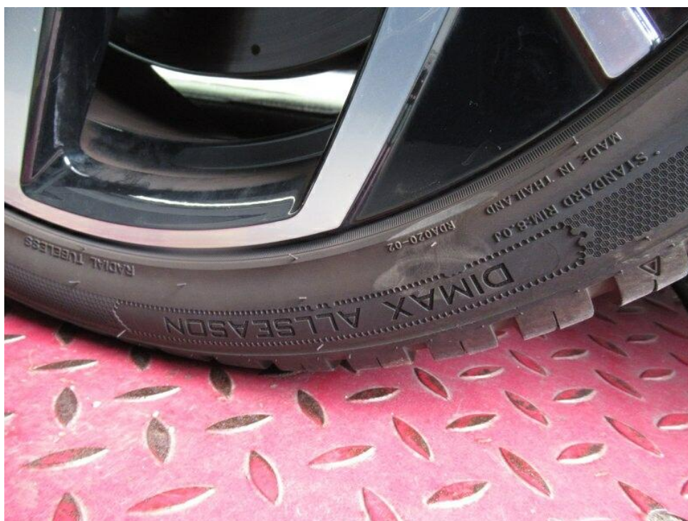
Bild 14 : Reifen vorne rechts ist ein Ganzjahresreifen, entspricht nicht dem Auslieferungszustand
