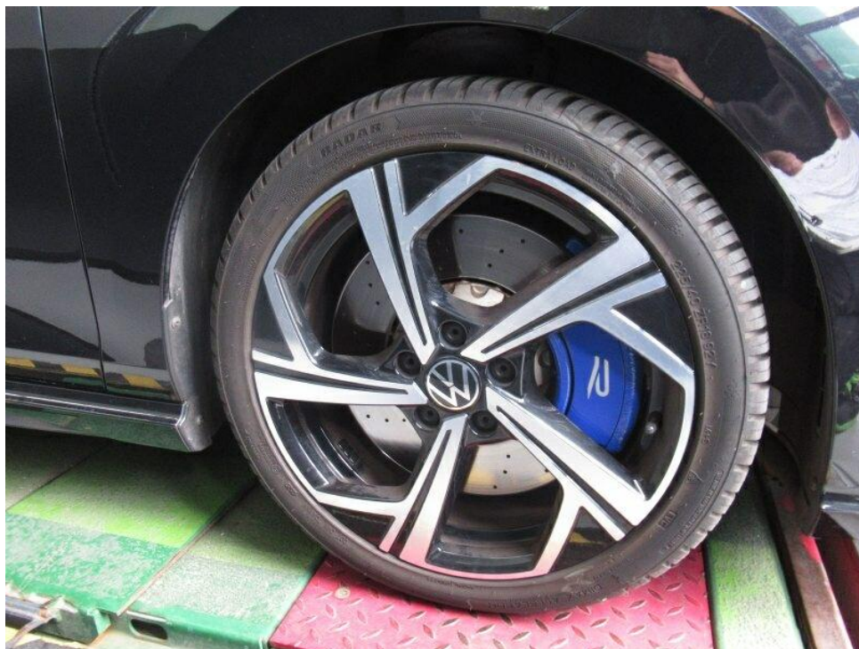
Bild 13 : Reifen vorne rechts ist ein Ganzjahresreifen, entspricht nicht dem Auslieferungszustand
