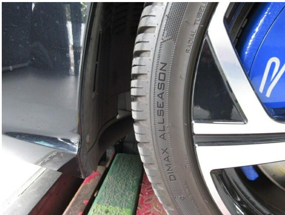
Bild 16 : Reifen vorne links ist ein Ganzjahresreifen, entspricht nicht dem Auslieferungszustand
