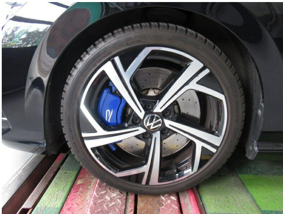
Bild 15 : Reifen vorne links ist ein Ganzjahresreifen, entspricht nicht dem Auslieferungszustand
