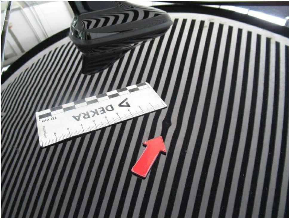
Bild 19 : Dach, eingedellt, drücken
