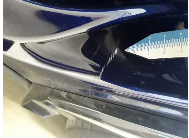
Beschädigung #1: Seitenwand links: Einstieg - Kratzer - Sm... Repair
