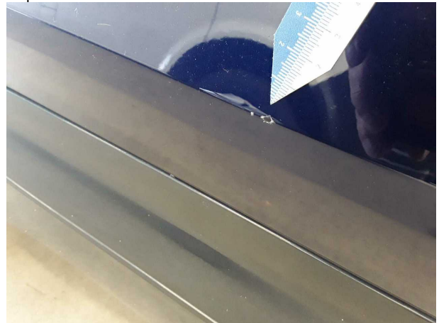
Beschädigung #2: Tür hinten rechts: Tür - Kratzer - instandsetzen und lackieren
