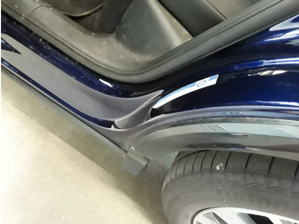
Beschädigung #1: Seitenwand links: Einstieg - Kratzer - Smart Repair
