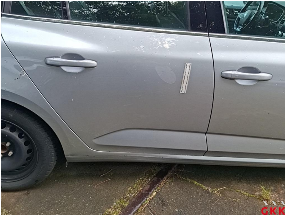
Bild 18. Tür hinten rechts, verkratzt, lackieren
