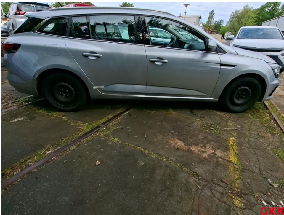
Bild 16. Schweller rechts, beschädigt, instand setzen - lackieren
