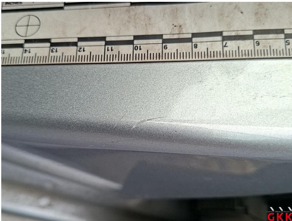
Bild 24. Tür vorne links, Einstieg, verkratzt, Smartrepair
