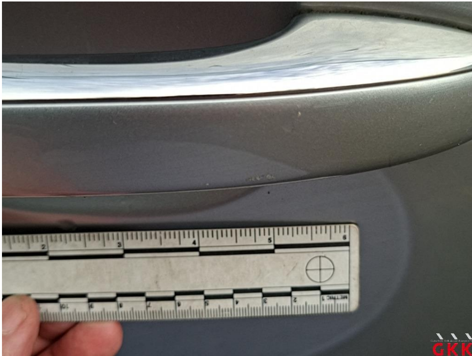
Bild 22. Tür vorne rechts, Griff, verkratzt, lackieren
