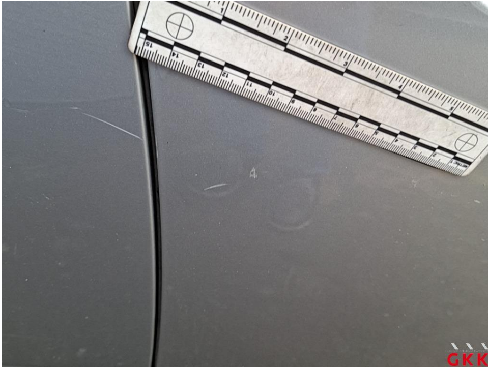
Bild 21. Tür vorne rechts, verkratzt, lackieren
