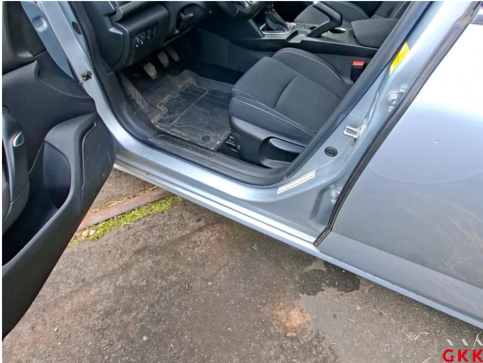
Bild 23. Tür vorne links, Einstieg, verkratzt, Smartrepair
