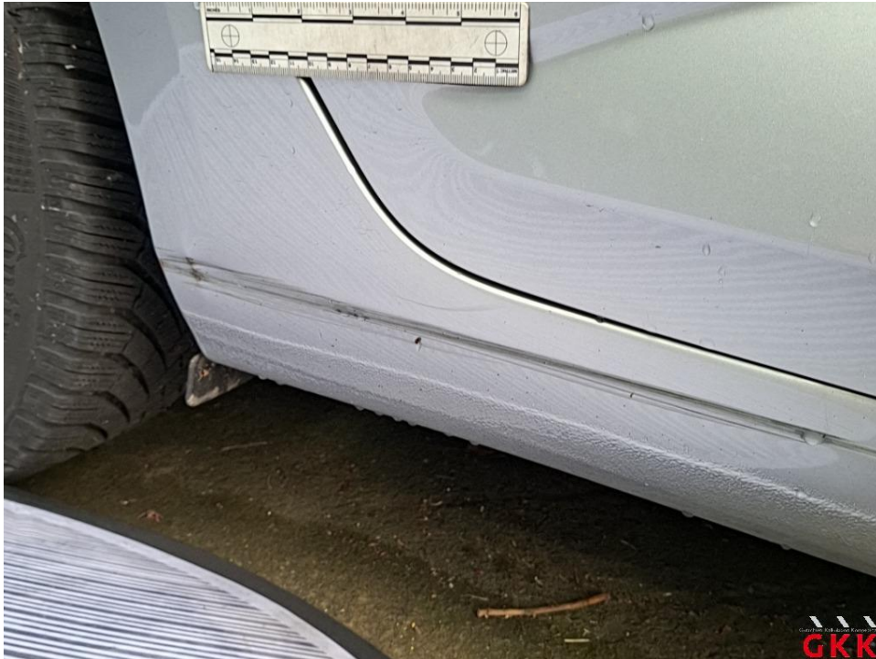
Bild 17. Schweller rechts, beschädigt, instand setzen - lackieren
