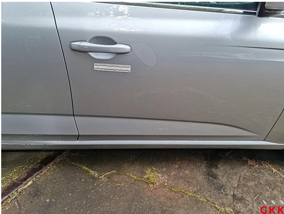
Bild 20. Tür vorne rechts, verkratzt, lackieren
