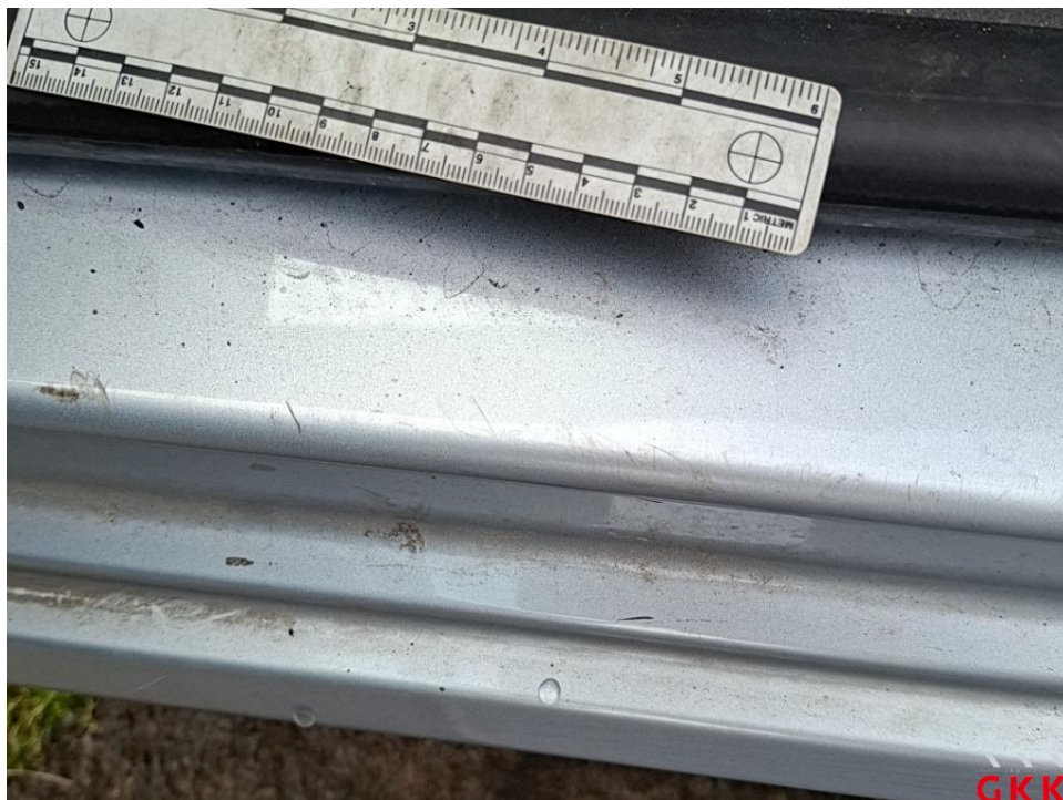
Bild 25. Tür vorne links, Einstieg, verkratzt, Smartrepair
