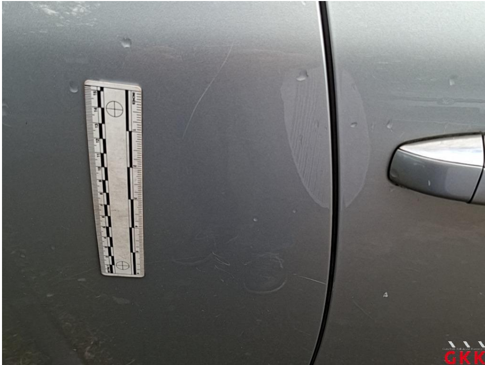
Bild 19. Tür hinten rechts, verkratzt, lackieren
