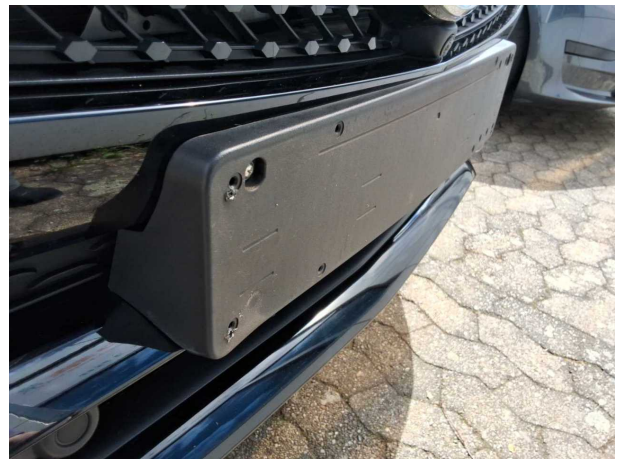
Beschädigung #3: Stossfänger vorn: Kennzeichenträger - beschädigt - erneuern
