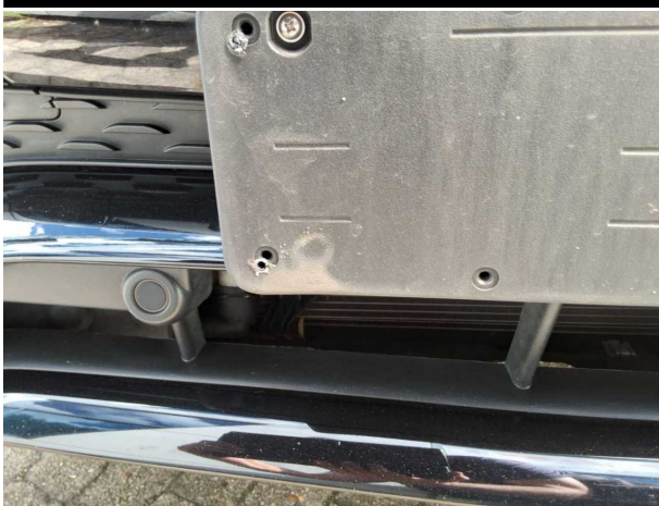
Beschädigung #3: Stossfänger vorn: Kennzeichenträger - beschädigt - erneuern
