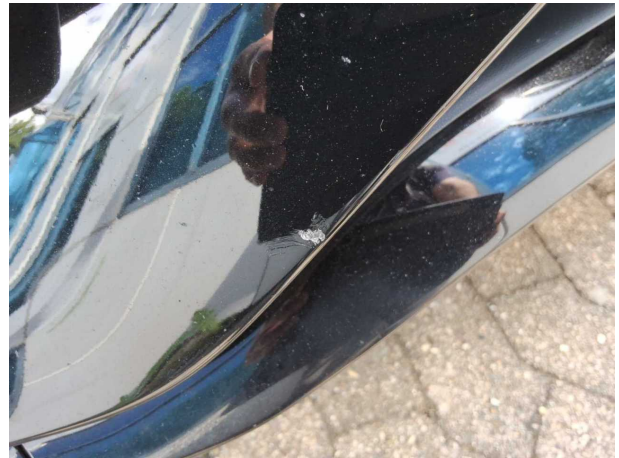
Beschädigung #7: Stossfänger vorn: Stossfänger vorn - Kratzer - lackieren
