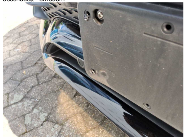
Beschädigung #3: Stossfänger vorn: Kennzeichenträger - beschädigt - erneuern
