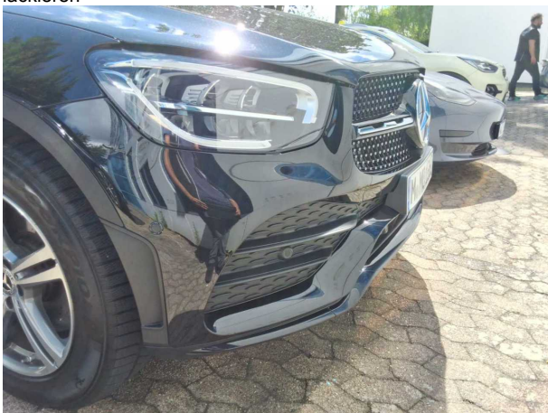
Beschädigung #7: Stossfänger vorn: Stossfänger vorn - Kratzer - lackieren
