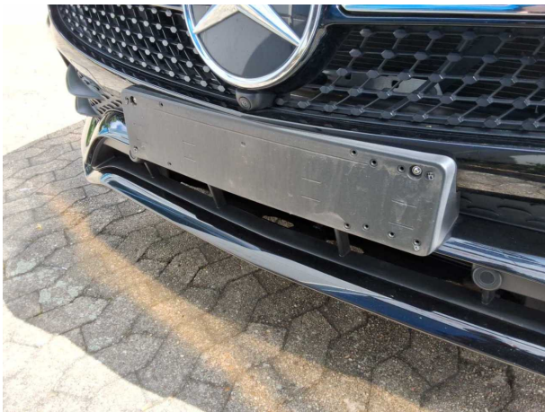
Beschädigung #3: Stossfänger vorn: Kennzeichenträger - beschädigt - erneuern
