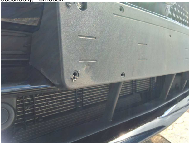
Beschädigung #3: Stossfänger vorn: Kennzeichenträger - beschädigt - erneuern
