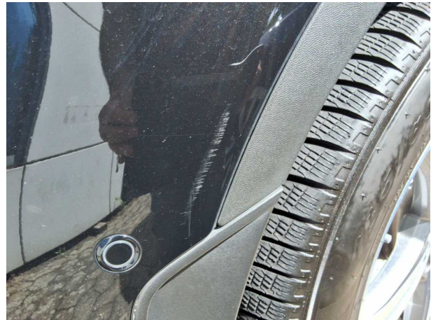
Beschädigung #7: Stossfänger vorn: Stossfänger vorn - Kratzer - lackieren
