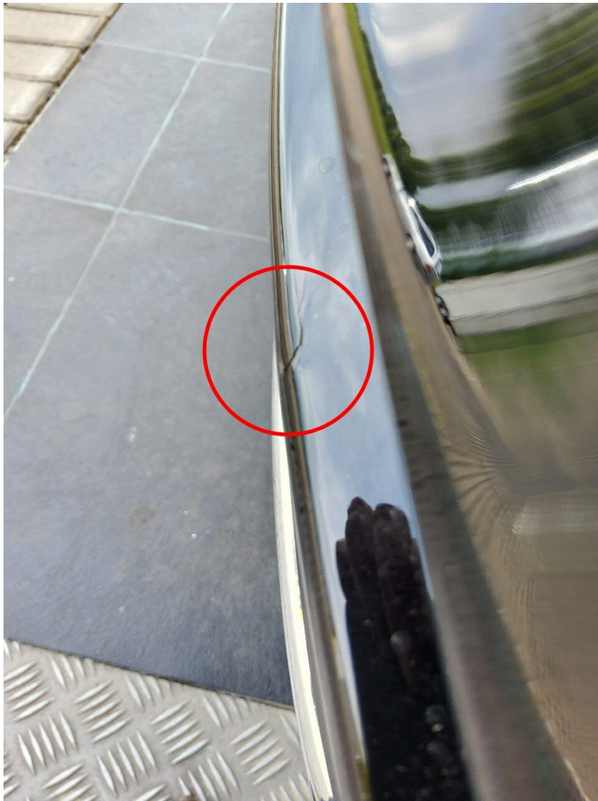
Bild 14 : Stoßfänger hinten angestoßen und gebrochen
