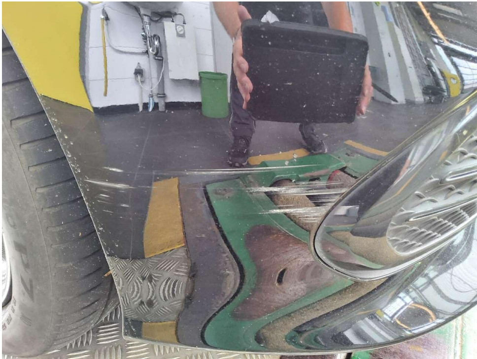
Bild 15 : Stoßfänger vorn rechts angestoßen Stoßfänger vorne, Steinschlag, Gebrauchsspur
