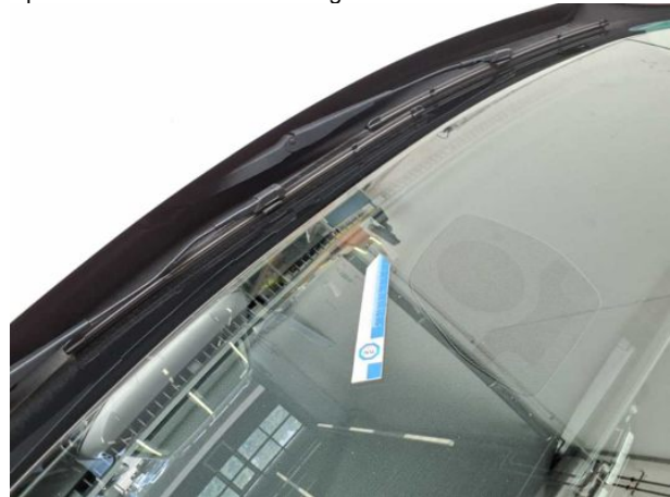
Beschädigung #6: Verglasung: Frontscheibe mit Spurhalteassistent - Steinschlag - erneuern
