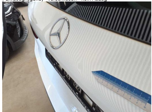
Beschädigung #2: Heckklappe/-tür: Heckklappe - Delle(n) - sanft instandsetzen
