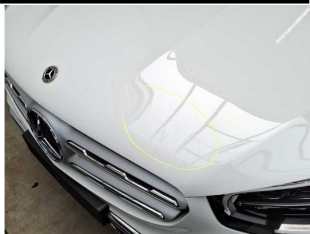
Beschädigung #5: Motorhaube: Motorhaube - Kratzer - instandsetzen und lackieren
