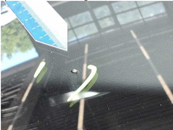
Beschädigung #6: Verglasung: Frontscheibe mit Spurhalteassistent - Steinschlag - erneuern
