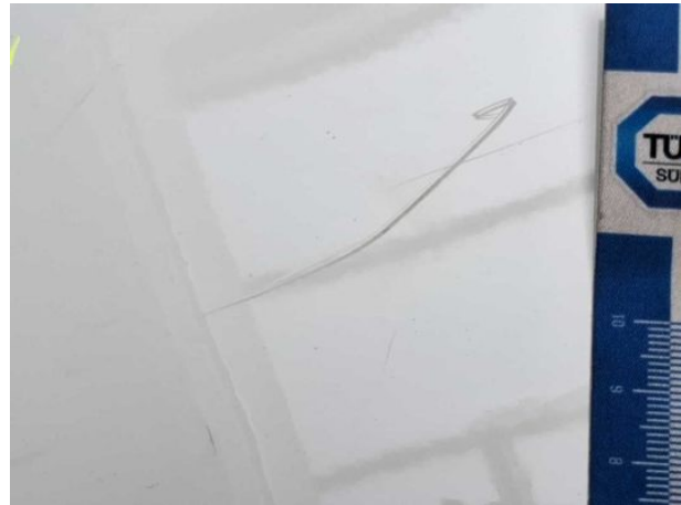
Beschädigung #5: Motorhaube: Motorhaube - Kratzer - instandsetzen und lackieren
