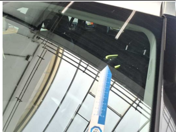
Beschädigung #6: Verglasung: Frontscheibe mit Spurhalteassistent - Steinschlag - erneuern
