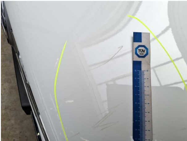
Beschädigung #5: Motorhaube: Motorhaube - Kratzer - instandsetzen und lackieren
