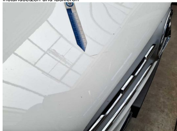
Beschädigung #5: Motorhaube: Motorhaube - Kratzer - instandsetzen und lackieren
