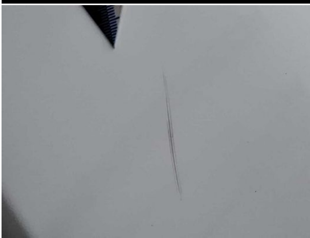
Beschädigung #4: Kotflügel rechts: Kotflügel rechts - Kratzer - instandsetzen und lackieren
