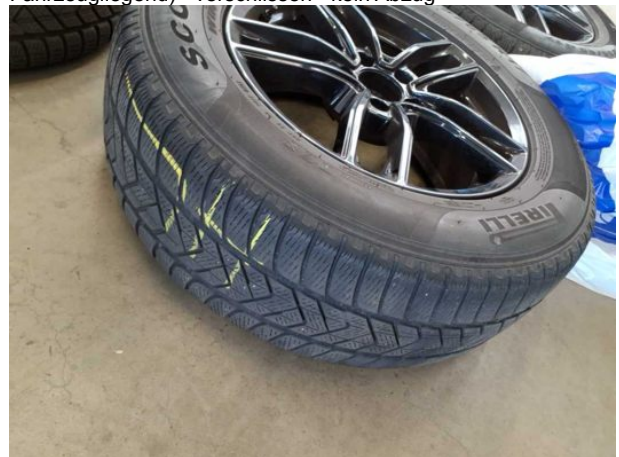
Beschädigung #1: 2.Radsatz: 2 Reifen (3mm im Fahrzeugliegend) - verschlissen - kein Abzug
