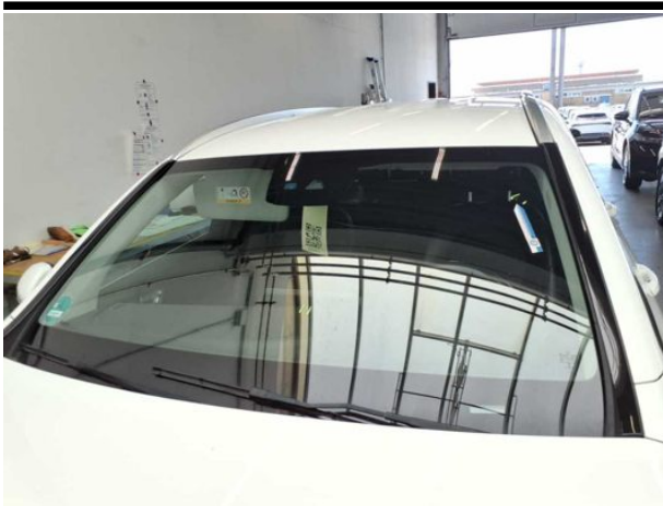
Beschädigung #6: Verglasung: Frontscheibe mit Spurhalteassistent - Steinschlag - erneuern
