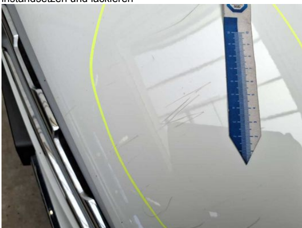
Beschädigung #5: Motorhaube: Motorhaube - Kratzer - instandsetzen und lackieren
