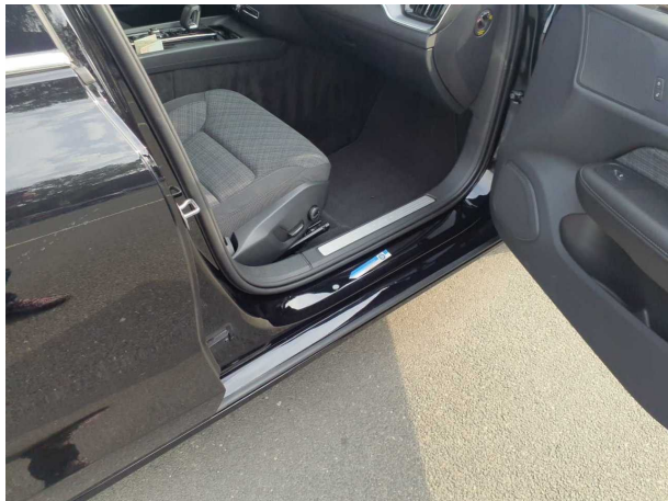
Beschädigung #1: Schweller rechts: Einstieg - Delle(n) - Smart Repair
