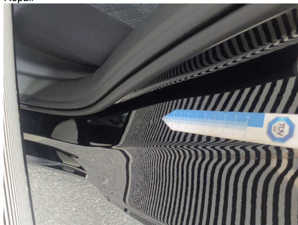
Beschädigung #2: Seitenwand links: Einstieg - Delle / Lackschaden - Smart Repair
