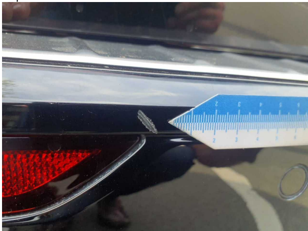
Beschädigung #4: Verkleidungen/Abdeckungen: Verkleidung Ladekante - Kratzer - Smart Repair
