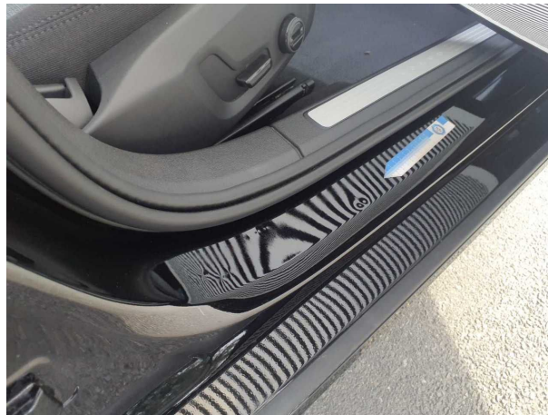
Beschädigung #1: Schweller rechts: Einstieg - Delle(n) - Smart Repair
