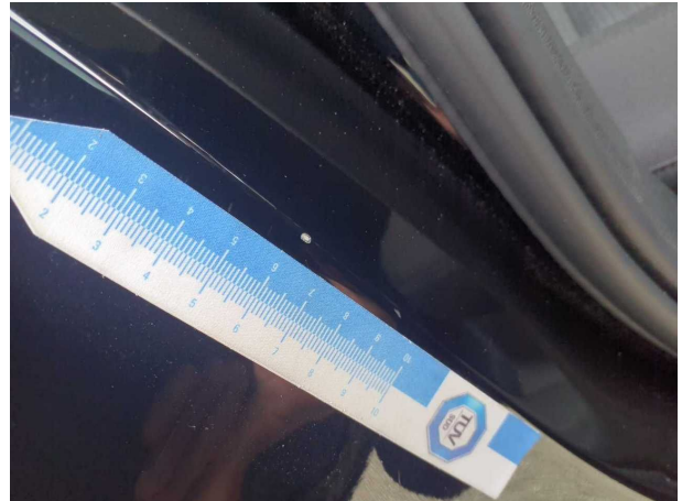
Beschädigung #3: Seitenwand rechts: Einstieg - Kratzer - Smart Repair
