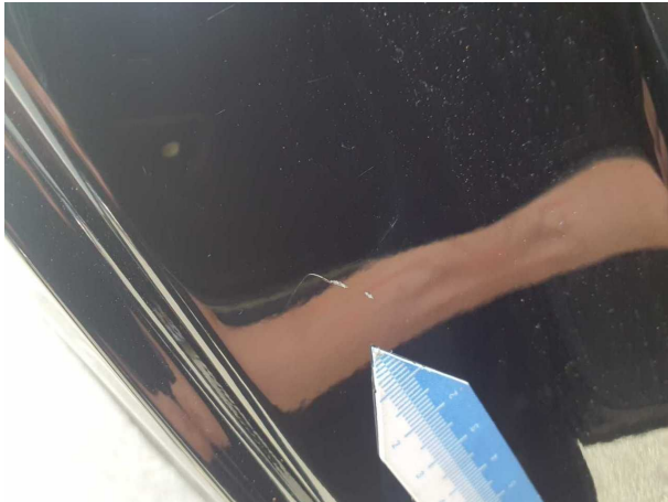
Beschädigung #3: Seitenwand rechts: Einstieg - Kratzer - Smart Repair
