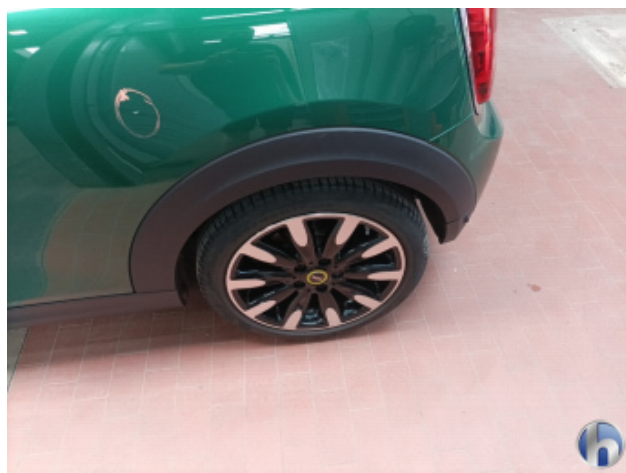
4. Reifen Hinten - Links Beschädigt - Erneuern
