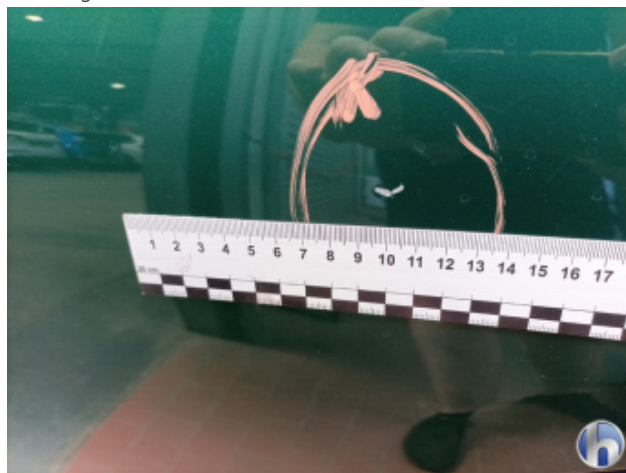
1. Seitenwand - Hinten - Links Kratzer - Smart Repair
