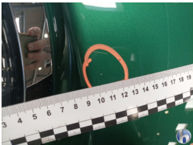
3. Motorhaube Gebrauchsspuren - Ohne Reparatur
