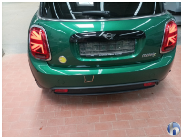
2. Stoßfänger Hinten Oberflächenkratzer - Aufbereiten / Polieren
