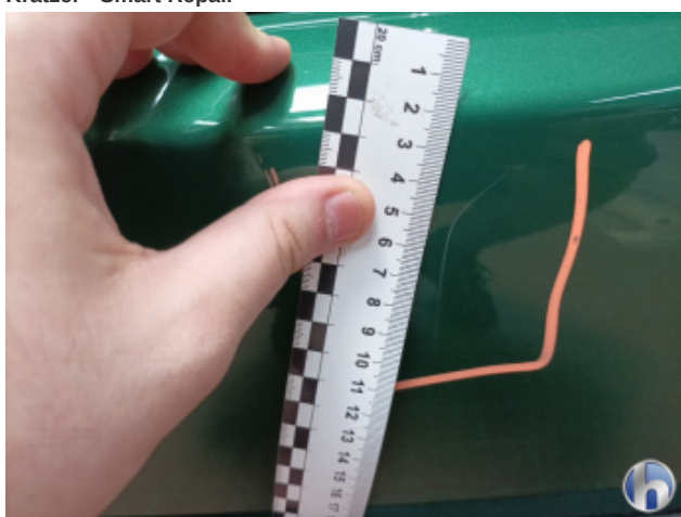
2. Stoßfänger Hinten Oberflächenkratzer - Aufbereiten / Polieren
