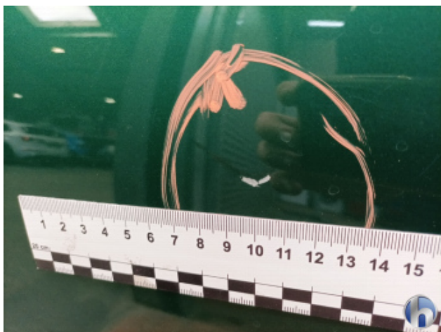
1. Seitenwand - Hinten - Links Kratzer - Smart Repair
