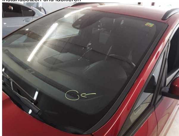
Beschädigung #6: Verglasung: Frontscheibe heizbar (Rissbildung) - Steinschlag - erneuern
