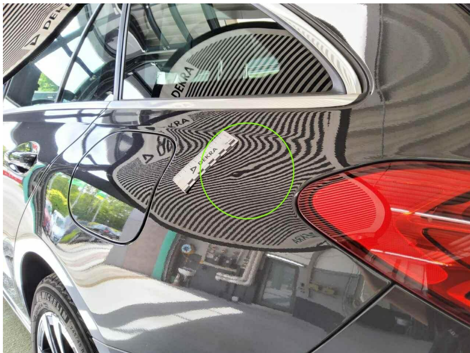
Bild 22 : Seitenteil hinten links, mehrfach eingedellt, drücken
