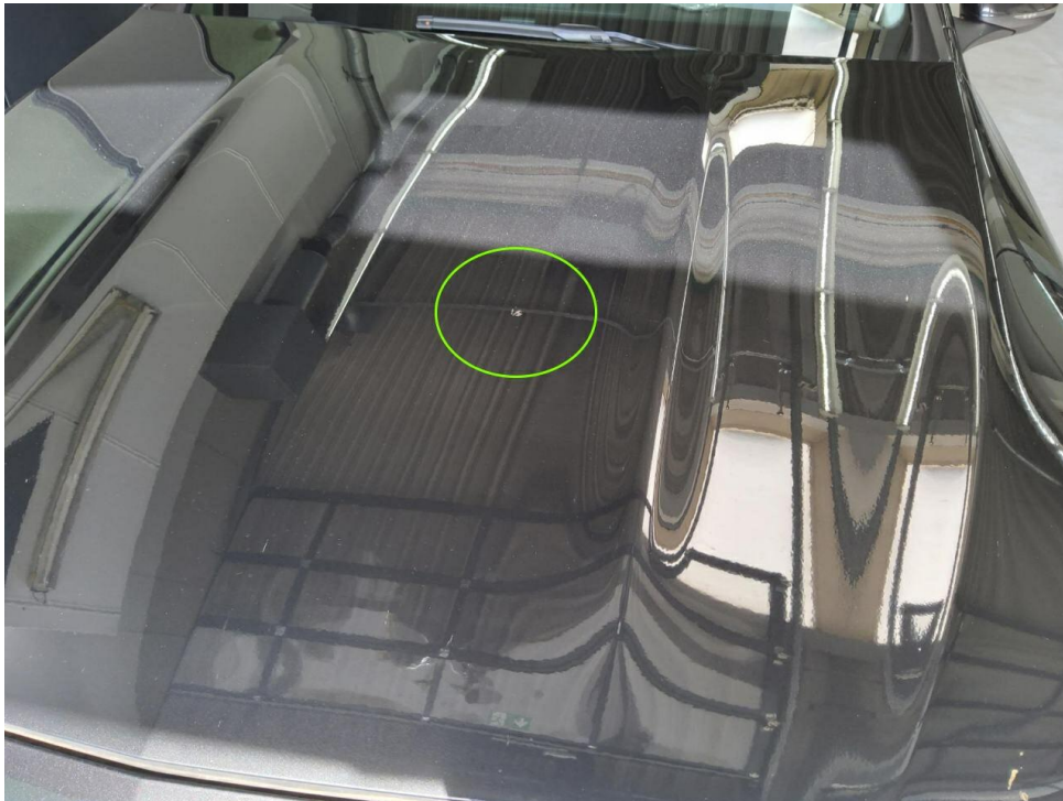
Bild 23 : Motorhaube Lackierung, Umweltschaden, polieren
