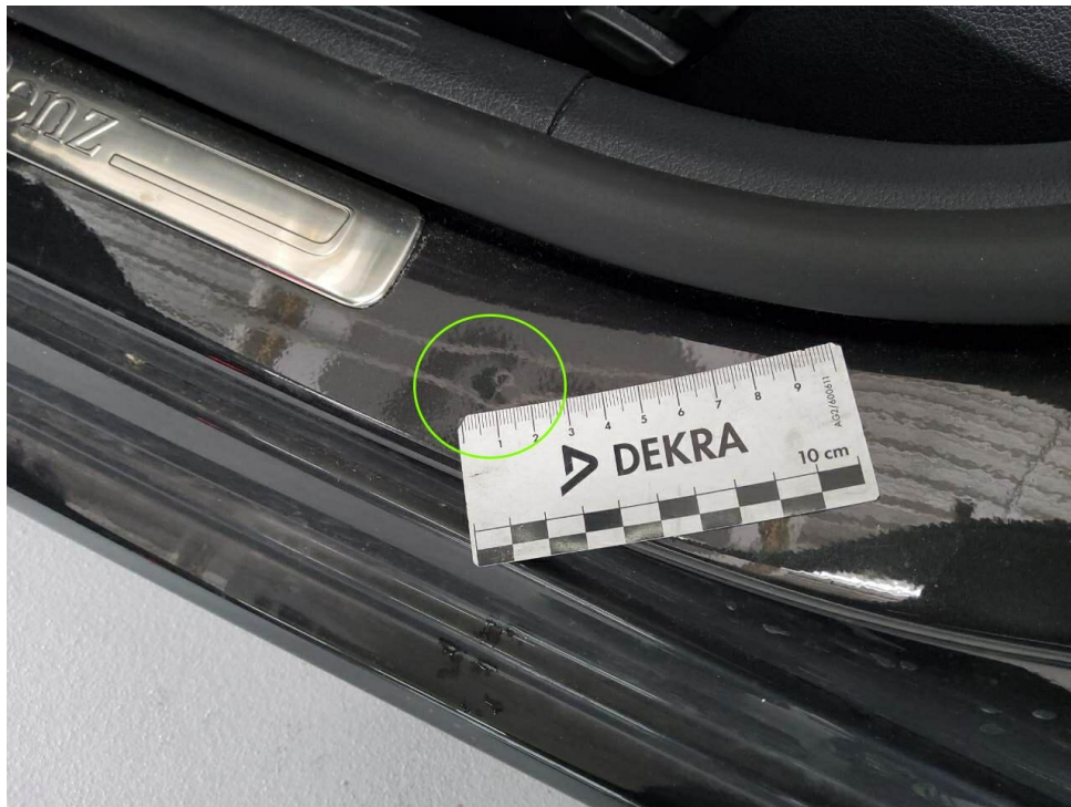
Bild 15 : Tür vorne links Einstieg, eingedellt, smart repair
