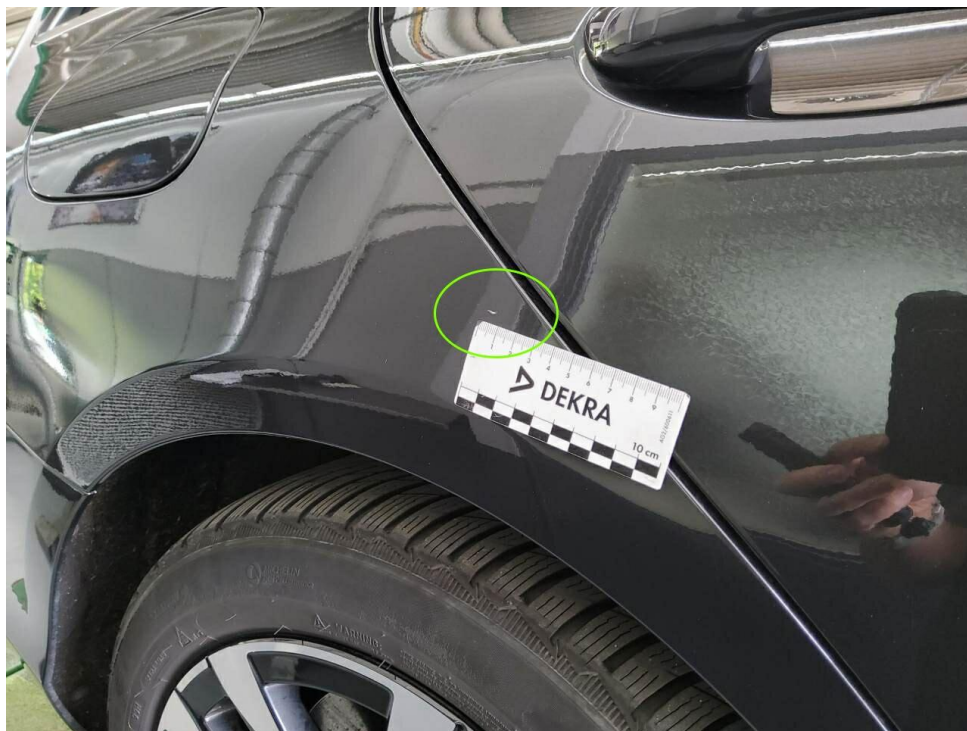
Bild 18 : Seitenteil hinten rechts Lackierung, zerkratzt, polieren
