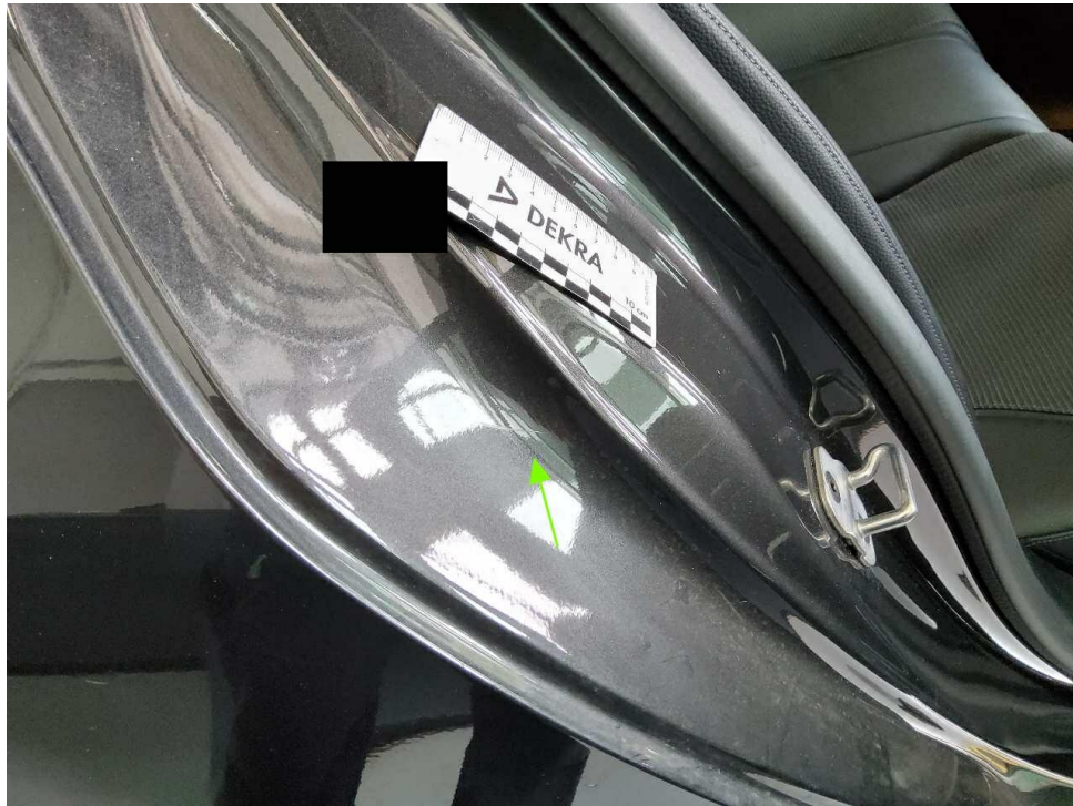
Bild 27 : Einstieg HR zerkratzt
