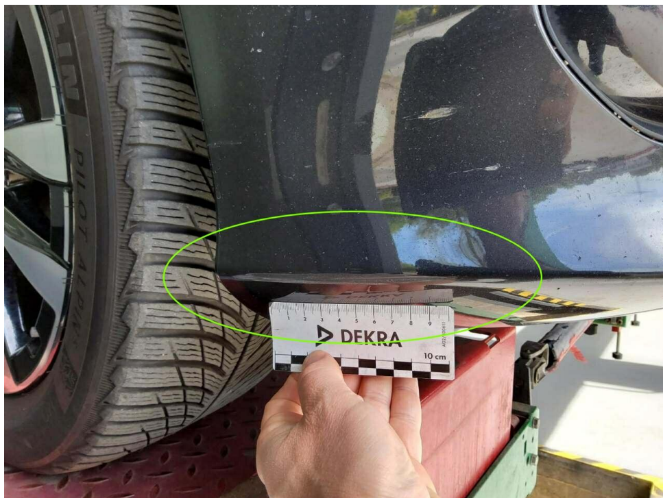
Bild 16 : Stoßfänger vorne Lackierung, verschrammt, smart repair
