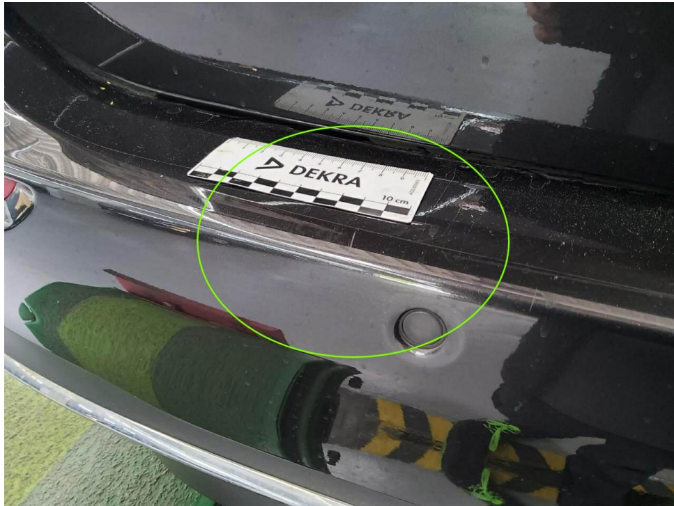
Bild 21 : Stoßfänger hinten Lackierung, zerkratzt, polieren
