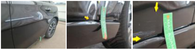
Garniture bas de caisse ext G, Déformé / Forcé, Le - Remplacer et peindre
