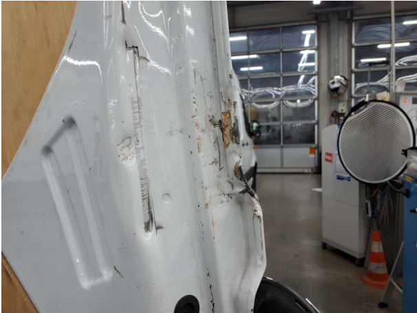
Beschädigung #17: Heckklappe/-tür: Hecktür rechts - verformt - erneuern
