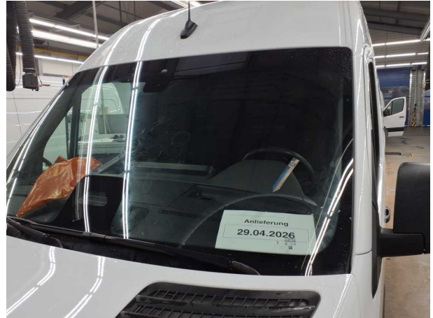
Beschädigung #16: Verglasung: Frontscheibe mit Spurhalteassistent - verkratzt / verschürft - erneuern
