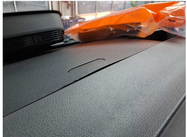
Beschädigung #10: Instrumententafel: Ablagefachdeckel - verfor... - erneuern
