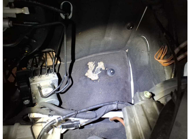
Beschädigung #2: Kotflügel links: Innenkotflügel - Marderschaden - erneuern
