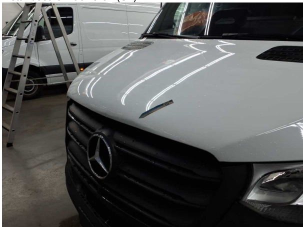
Beschädigung #15: Motorhaube: Motorhaube - verformt - erneuern
