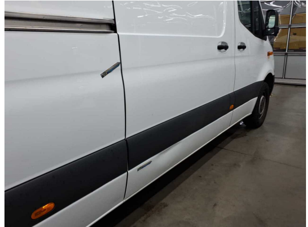
Beschädigung #14: Schiebetür rechts: Schiebetür - verformt - instandsetzen/lackieren (S1)
