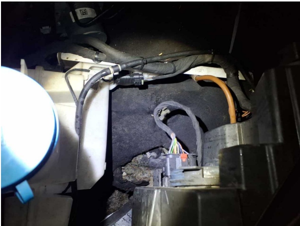
Beschädigung #2: Kotflügel links: Innenkotflügel - Marderschaden - erneuern
