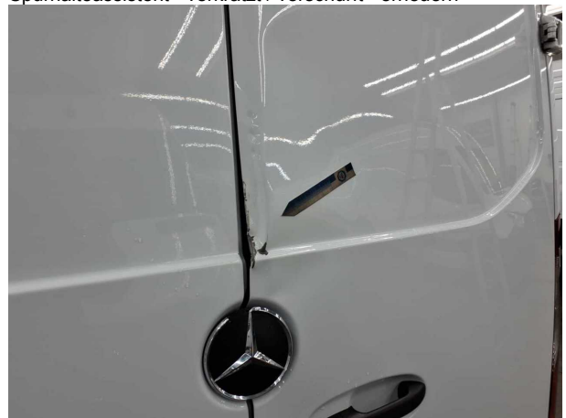
Beschädigung #17: Heckklappe/-tür: Hecktür rechts - verformt - erneuern
