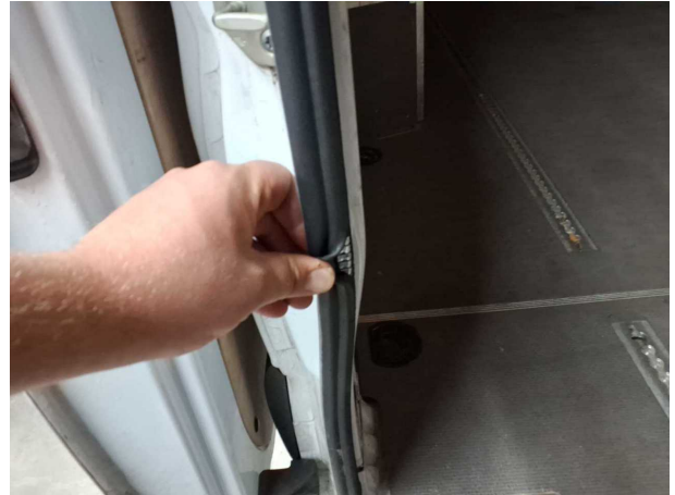
Beschädigung #5: Schiebetür rechts: Türdichtung - gebrochen / gerissen - erneuern
