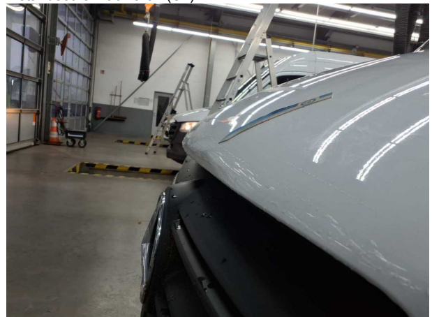
Beschädigung #15: Motorhaube: Motorhaube - verformt - erneuern
