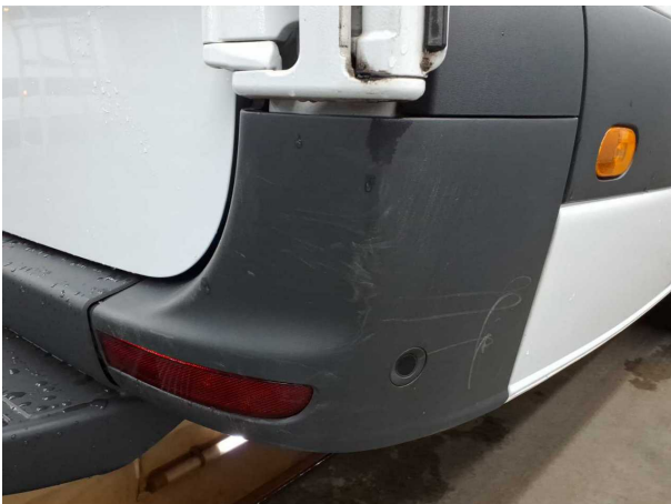
Beschädigung #11: Stossfänger hinten: Stossfänger hinten rechts - verkratzt / verschürft - erneuern
