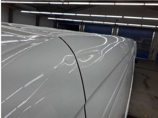
Beschädigung #13: Fahrzeugdach: Dach (Seitenteil A + B) - verformt - instandsetzen und lackieren
