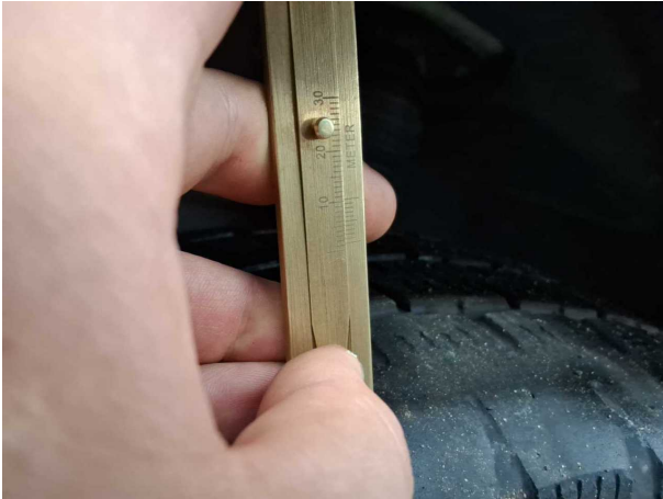
Beschädigung #8: Rad/Reifen: Reifen vorn links - verschlissen - erneuern
