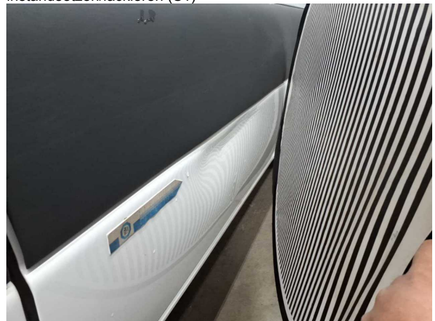
Beschädigung #14: Schiebetür rechts: Schiebetür - verformt - instandsetzen/lackieren (S1)
