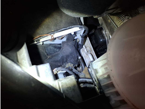
Beschädigung #1: Kotflügel rechts: Innenkotflügel - Marderschaden - erneuern
