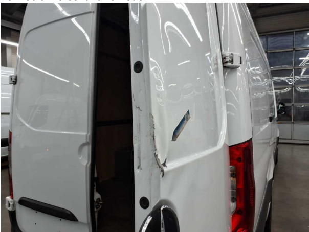
Beschädigung #17: Heckklappe/-tür: Hecktür rechts - verformt - erneuern
