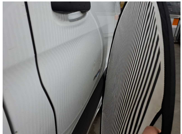
Beschädigung #3: Tür vorn rechts: Tür - Delle(n) - Smart Repair
