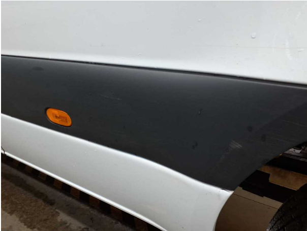
Beschädigung #4: Seitenwand links: Schutzleiste (Mitte) - verkratzt / verschürft - erneuern
