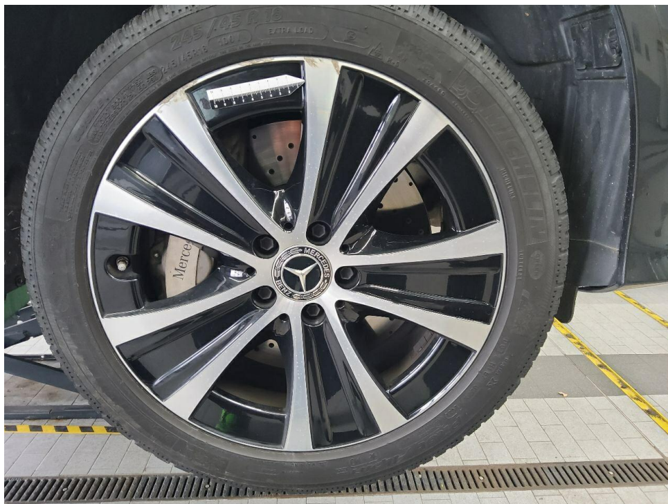
Bild 7 : Glanzgedrehte Winterfelge vorne rechts, zerkratzt mit Materialabtrag
