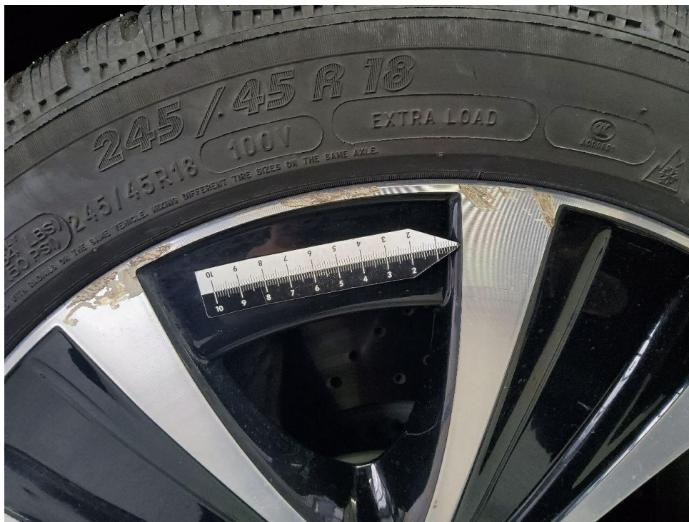
Bild 8 : Glanzgedrehte Winterfelge vorne rechts, zerkratzt mit Materialabtrag
