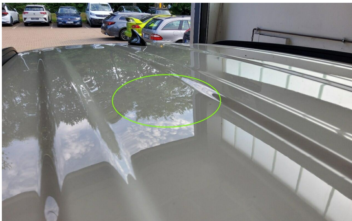
Bild 6 : Dach, mehrfach eingedellt
