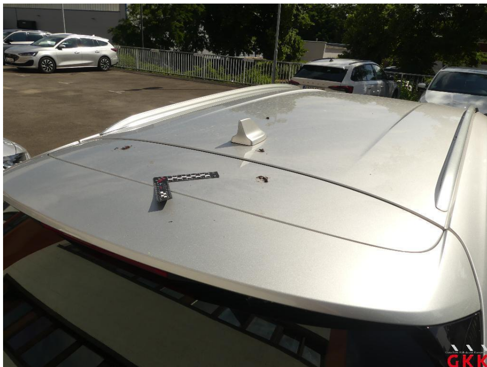
Bild 20. Heckklappe, bis 3 Dellen / Bauteil, kalt drücken
