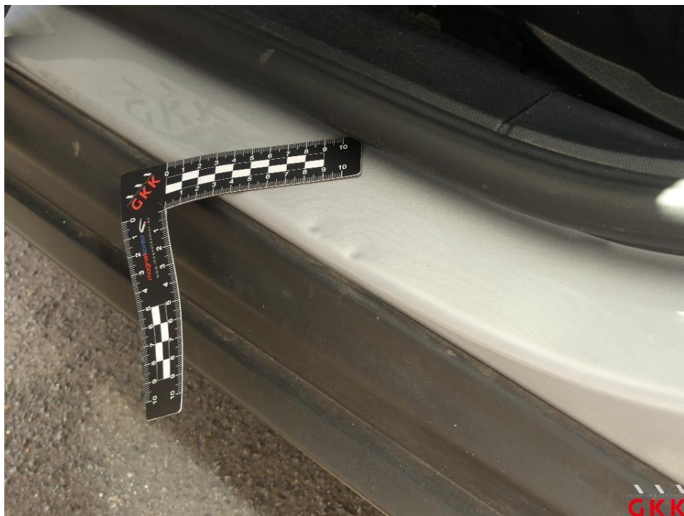
Bild 19. Tür vorne links, Einstieg, beschädigt, instand setzen - lackieren
