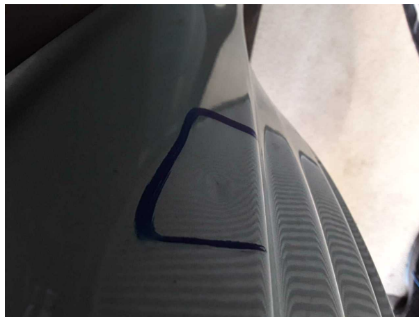
Beschädigung #3: Seitenwand rechts: Einstieg - Delle(n) - sanft instandsetzen
