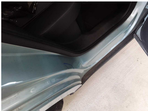
Beschädigung #3: Seitenwand rechts: Einstieg - Delle(n) - sanft instandsetzen
