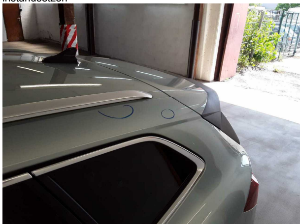
Beschädigung #4: Fahrzeugdach: Dachholm links - Delle(n) - sanft instandsetzen
