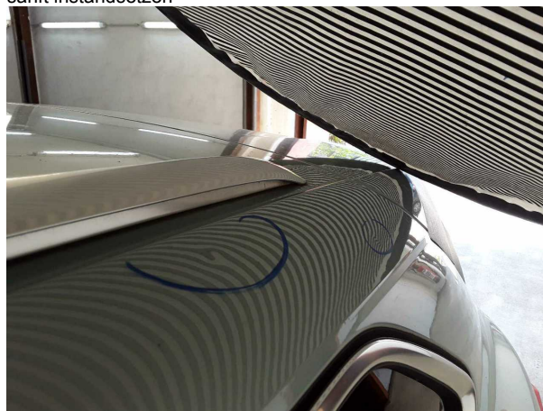
Beschädigung #4: Fahrzeugdach: Dachholm links - Delle(n) - sanft instandsetzen
