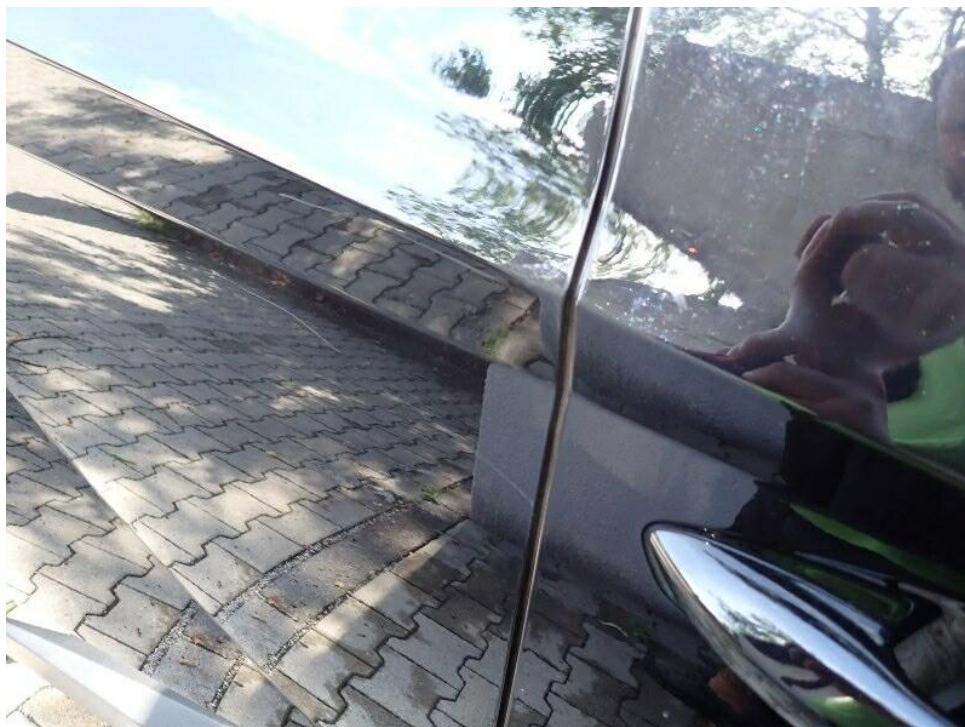
Bild 18 : Diverse oberflächige Kratzer und Abrieb, polieren, prüfen
