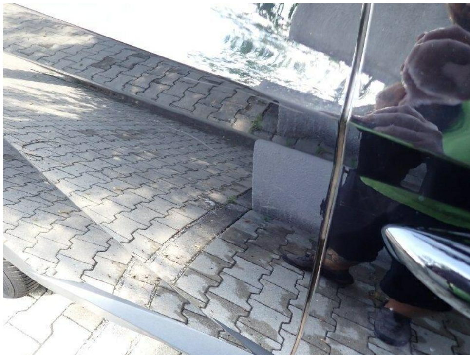
Bild 17 : Diverse oberflächige Kratzer und Abrieb, polieren, prüfen
