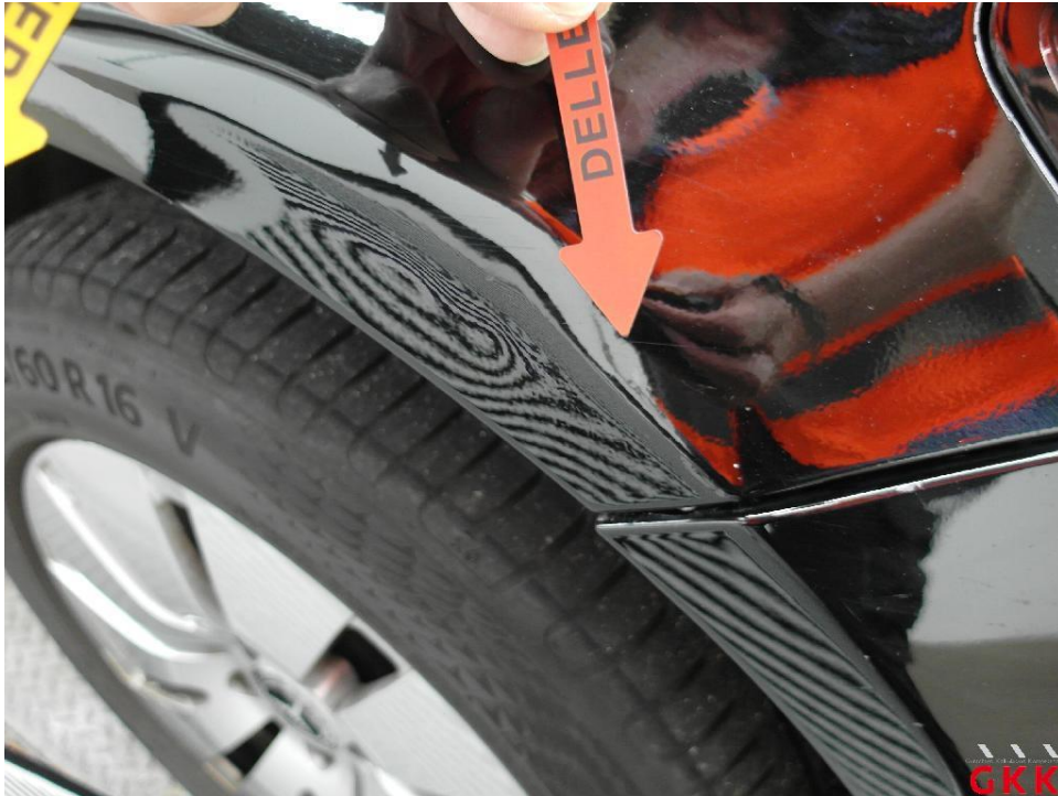
Bild 17. Kotflügel vorne rechts, beschädigt, ersetzen
