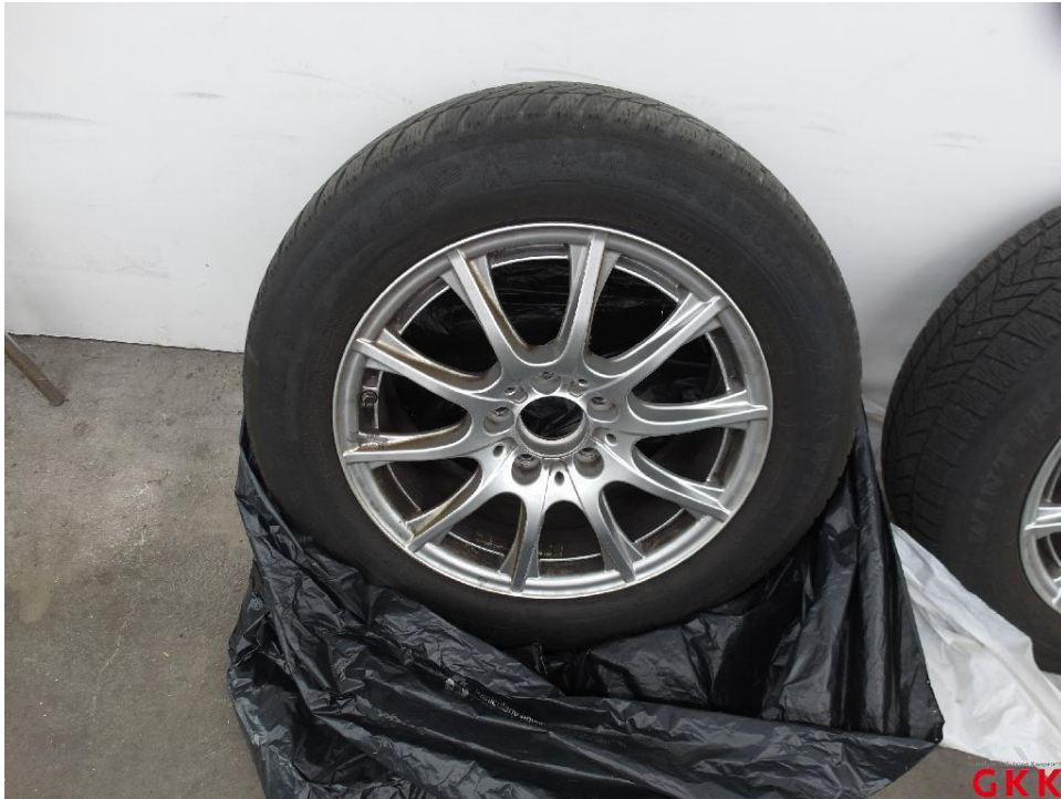
Bild 29. Reifen, 1 x beiliegend, Untermaß, ersetzen
