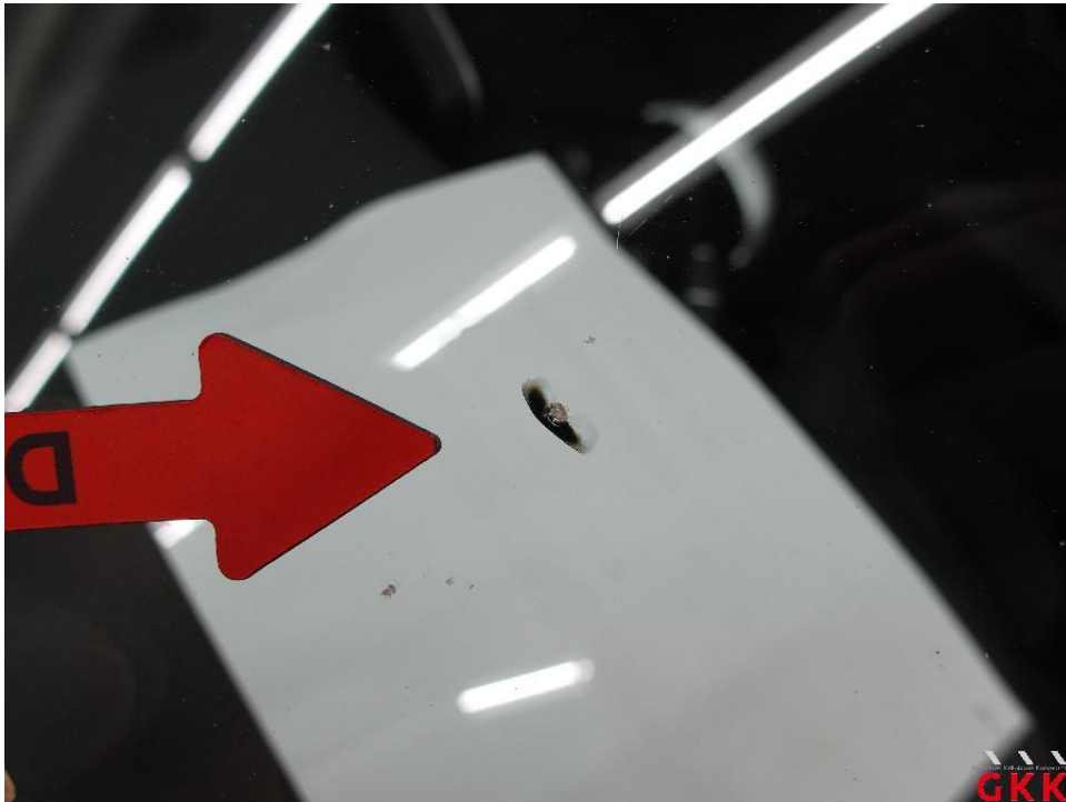
Bild 22. Frontscheibe, mit Regensensor und Frontkamera, Steinschlag mit Rissbildung, ersetzen
