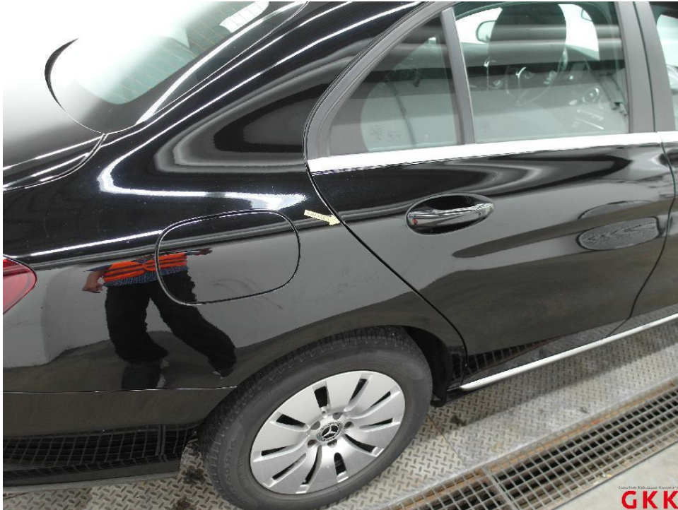
Bild 23. Tür hinten rechts, Kante, verkratzt, auslegen, schleifen, polieren
