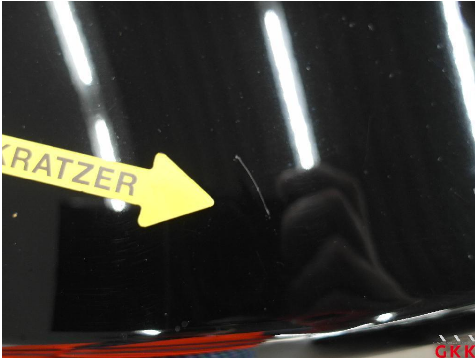
Bild 28. Heckklappe, verkratzt, auslegen, schleifen, polieren
