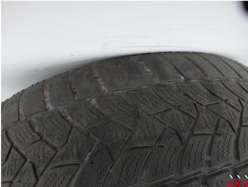
Bild 30. Reifen, 1 x beiliegend, Untermaß, ersetzen
