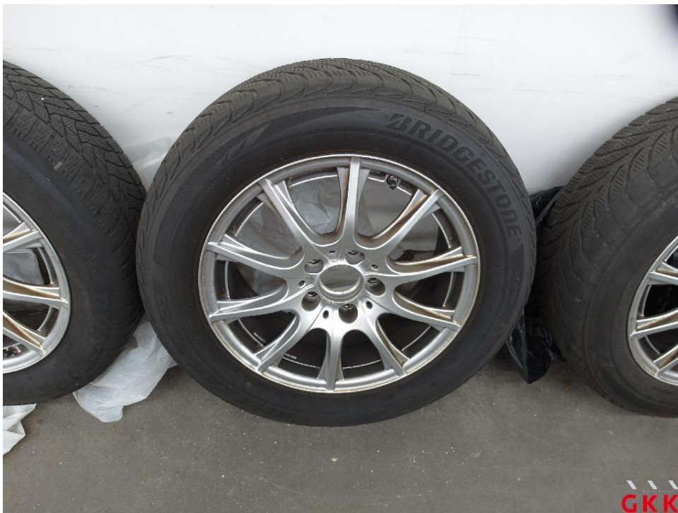
Bild 34. Reifen, 1 x beiliegend, einseitig abgefahren, ersetzen
