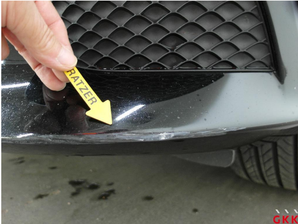
Bild 15. Stoßfänger vorne, Verkleidung -lackiert-, beschädigt, Smartrepair
