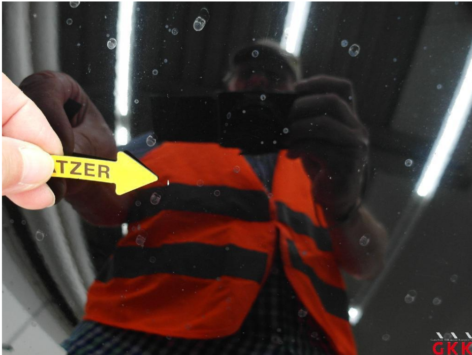
Bild 20. Motorhaube, Steinschlag, auslegen, schleifen, polieren
