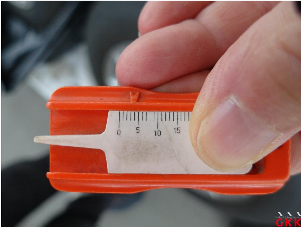
Bild 33. Reifen, 1 x beiliegend, Untermaß, ersetzen
