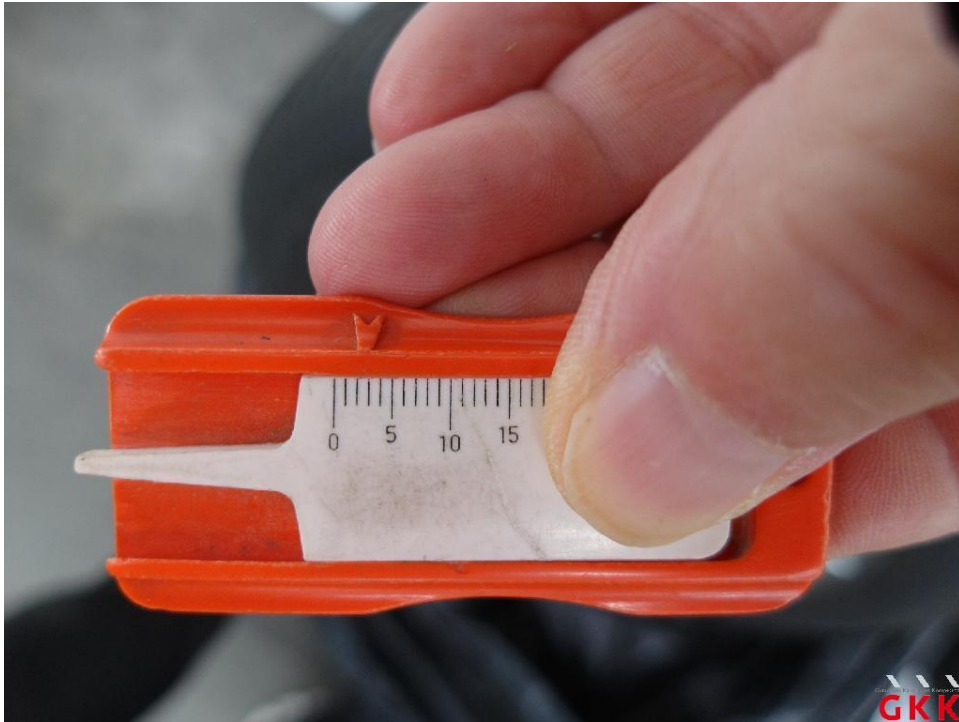
Bild 31. Reifen, 1 x beiliegend, Untermaß, ersetzen
