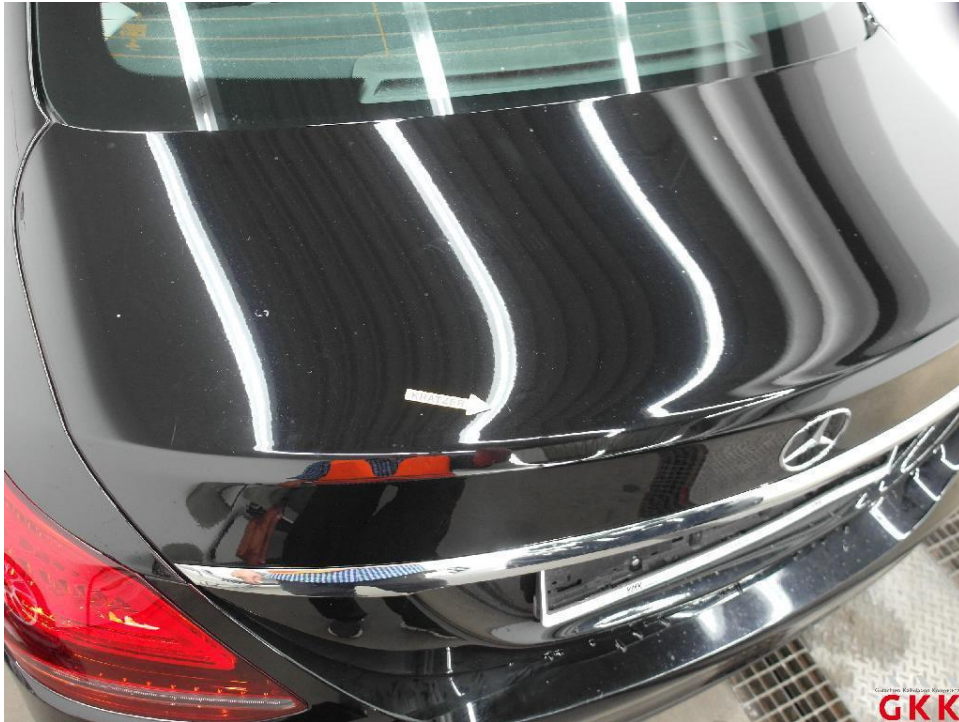
Bild 27. Heckklappe, verkratzt, auslegen, schleifen, polieren
