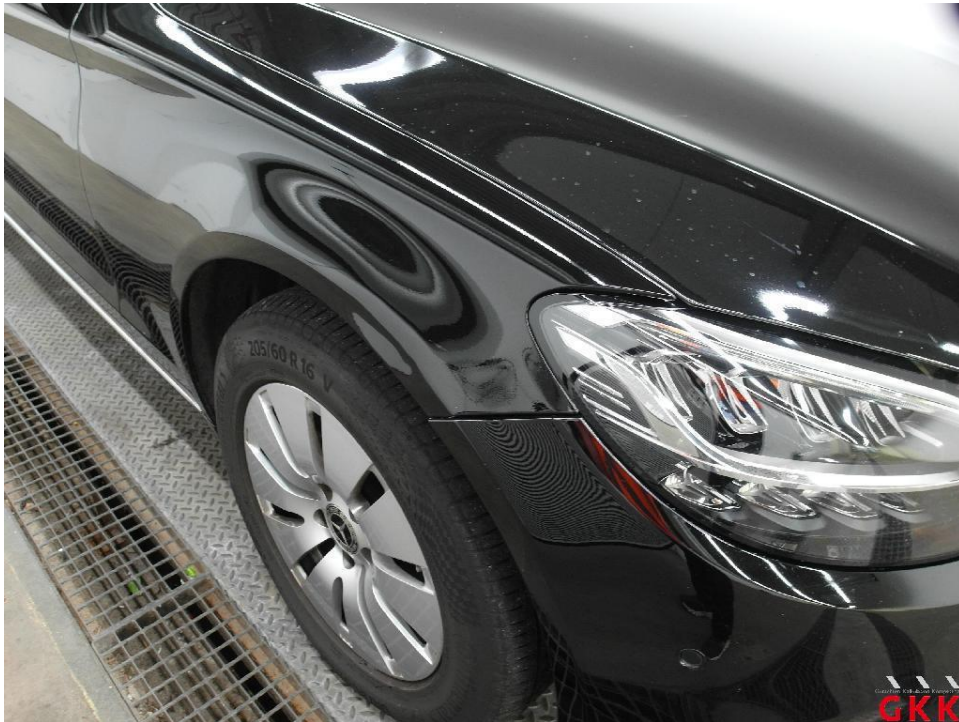
Bild 16. Kotflügel vorne rechts, beschädigt, ersetzen
