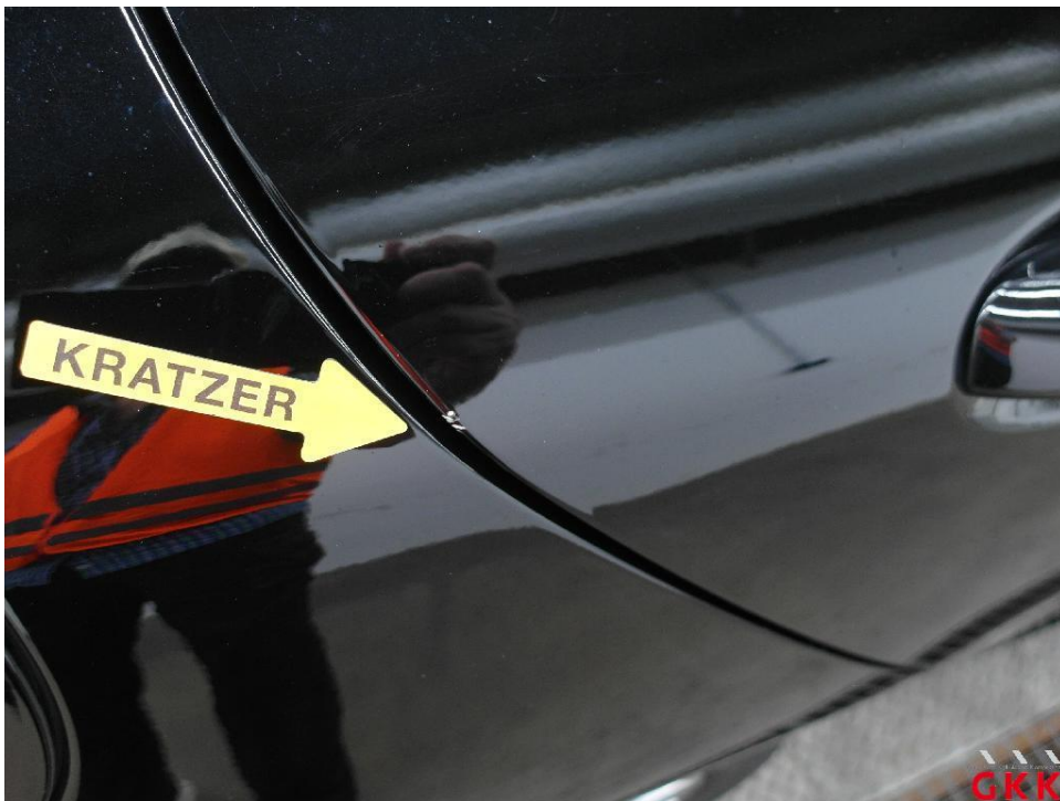
Bild 24. Tür hinten rechts, Kante, verkratzt, auslegen, schleifen, polieren
