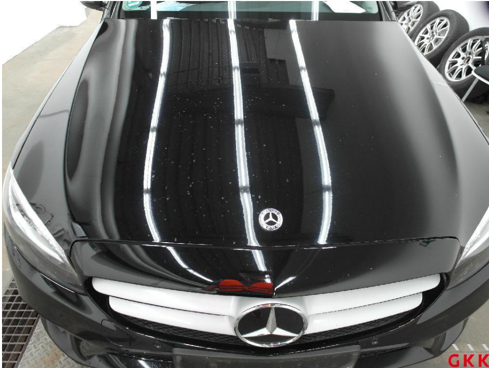
Bild 19. Motorhaube, Steinschlag, auslegen, schleifen, polieren
