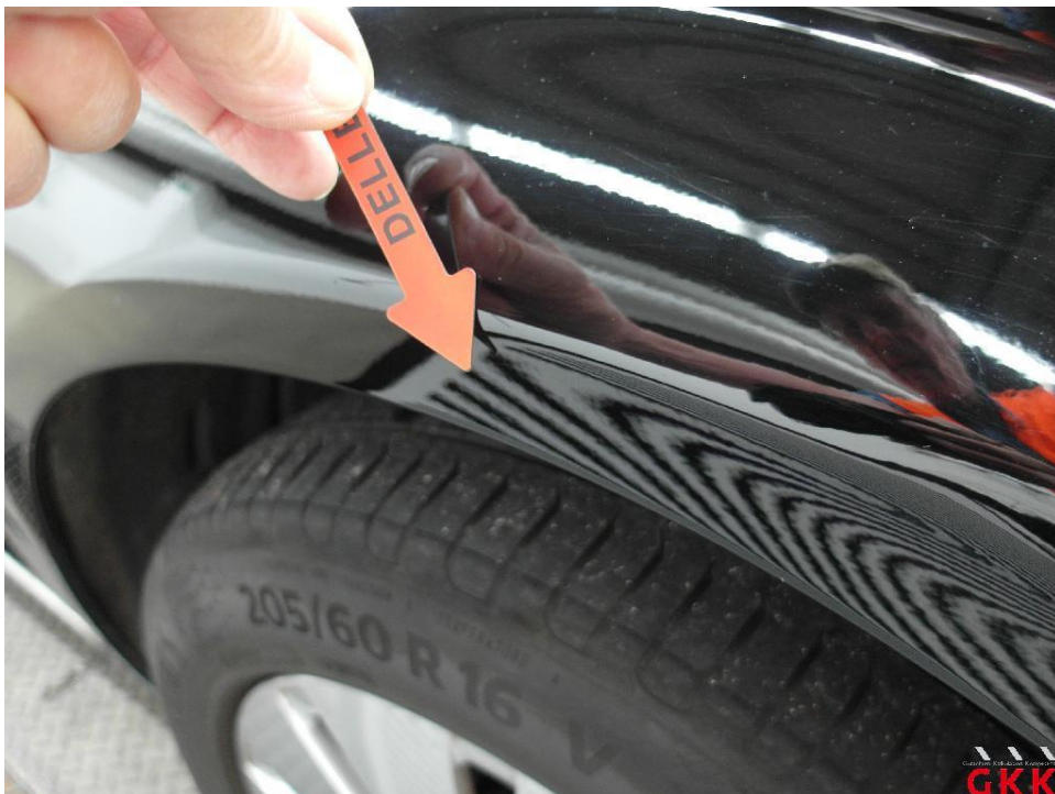
Bild 18. Kotflügel vorne rechts, beschädigt, ersetzen
