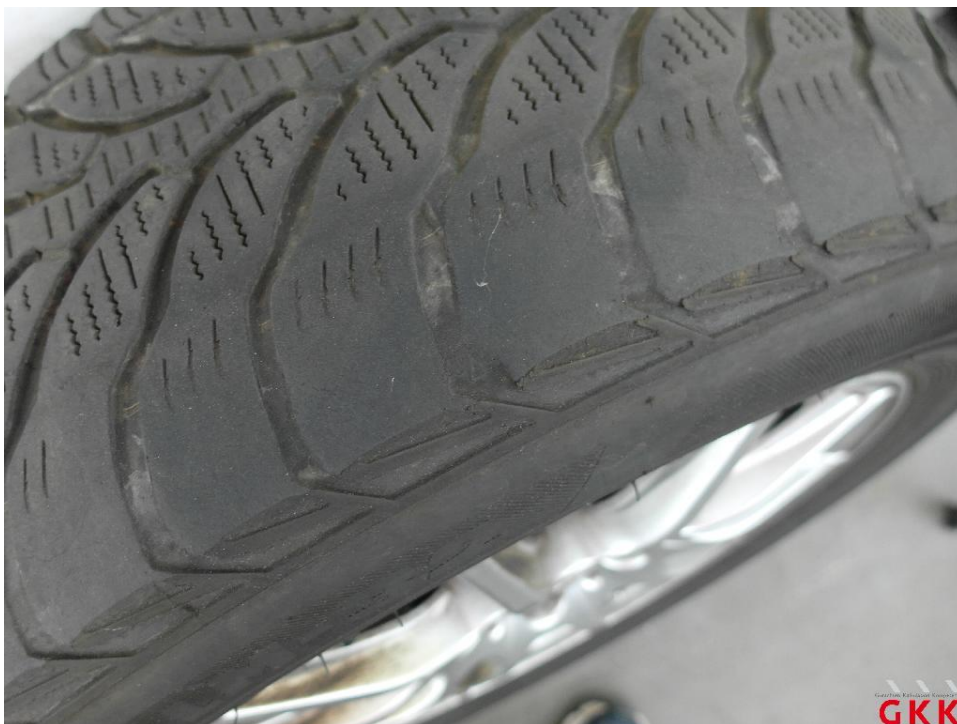
Bild 39. Reifen, 1 x beiliegend, einseitig abgefahren, ersetzen
