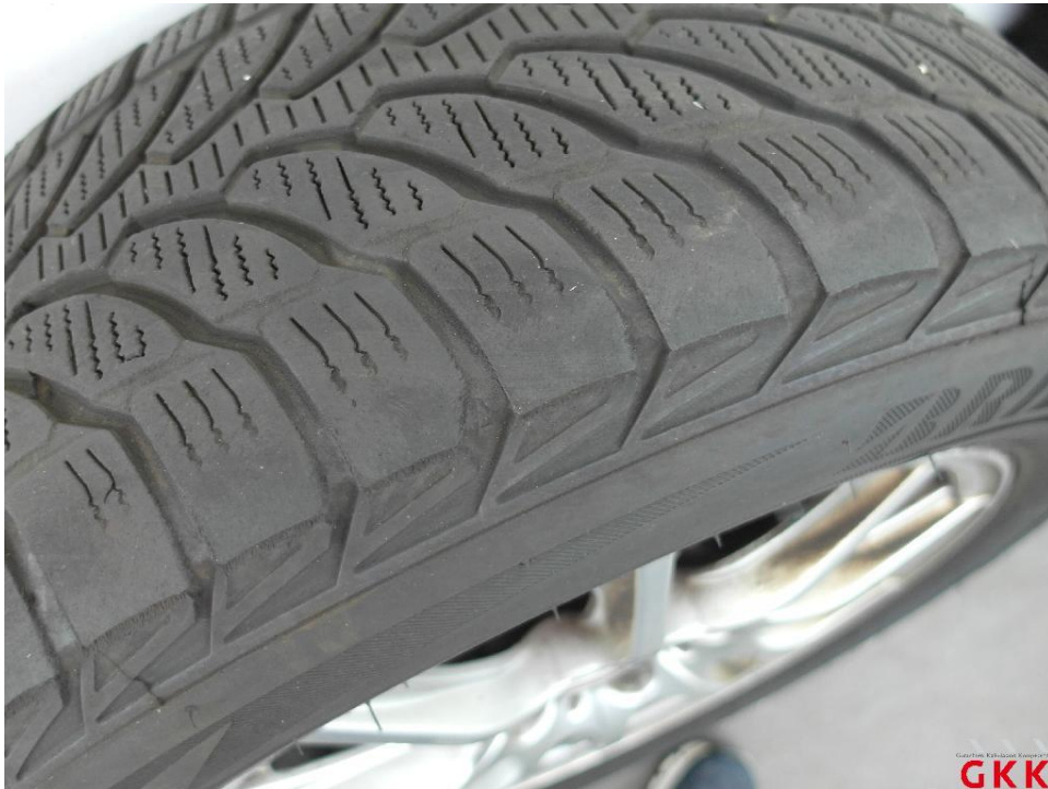
Bild 36. Reifen, 1 x beiliegend, einseitig abgefahren, ersetzen
