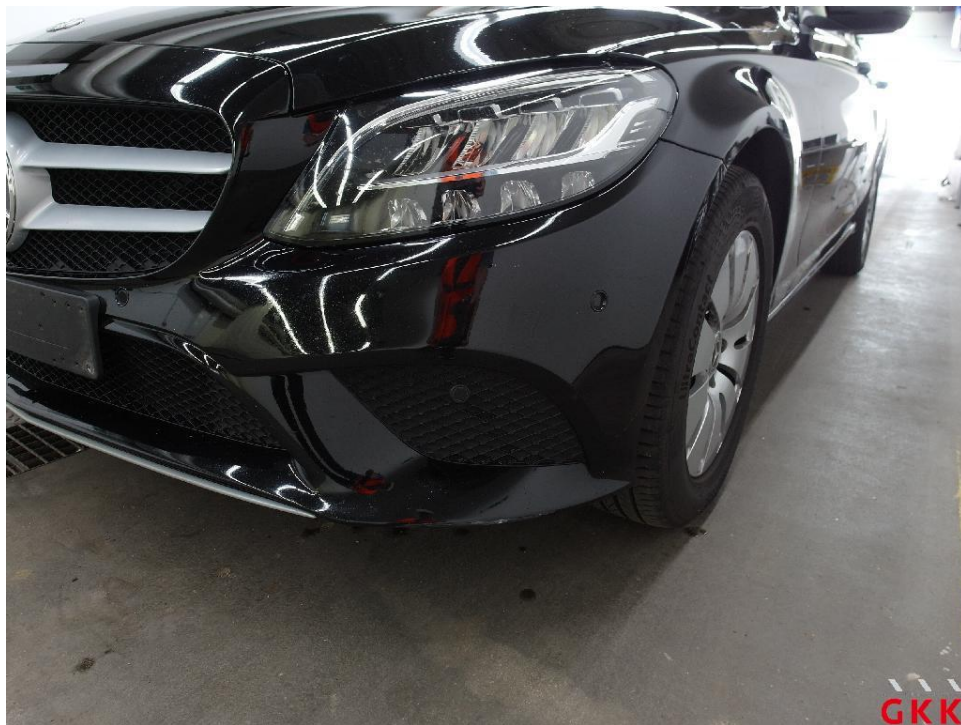
Bild 14. Stoßfänger vorne, Verkleidung -lackiert-, beschädigt, Smartrepair
