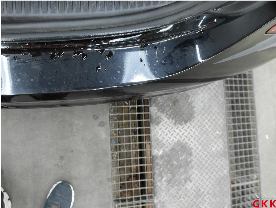
Bild 25. Stoßfänger hinten, Verkleidung oberhalb -lackiert-, verkratzt, auslegen, schleifen, polieren
