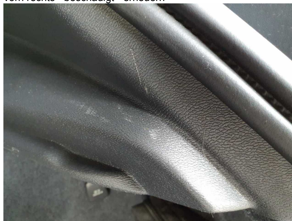
Beschädigung #5: Verkleidungen/Abdeckungen: Kofferraumverkleidung - Kratzer - Wertminderung
