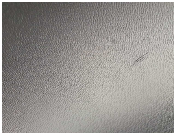
Beschädigung #8: Verkleidungen/Abdeckungen: Heckdeckel, Innenverkleidung - Kratzer - Wertminderung
