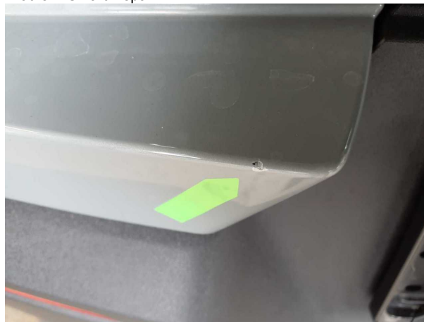
Beschädigung #10: Stossfänger hinten: Stossfänger hinten - Kratzer - Smart Repair
