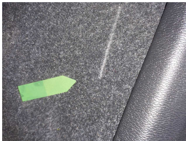
Beschädigung #4: Verkleidungen/Abdeckungen: Teppichboden vorn rechts - beschädigt - erneuern
