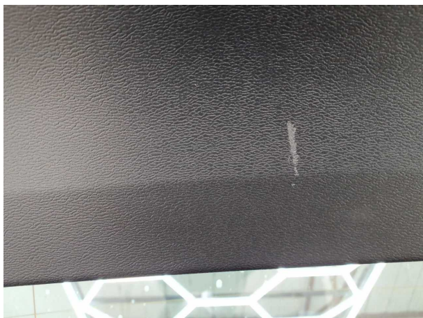
Beschädigung #8: Verkleidungen/Abdeckungen: Heckdeckel, Innenverkleidung - Kratzer - Wertminderung
