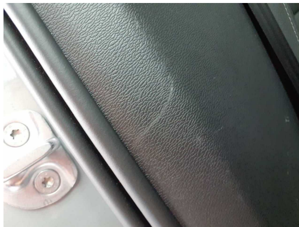
Beschädigung #2: Verkleidungen/Abdeckungen: C-Säule rechts Verkleidung innen - Kratzer - Wertminderung
