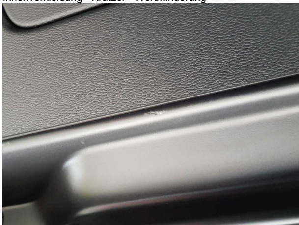
Beschädigung #8: Verkleidungen/Abdeckungen: Heckdeckel, Innenverkleidung - Kratzer - Wertminderung
