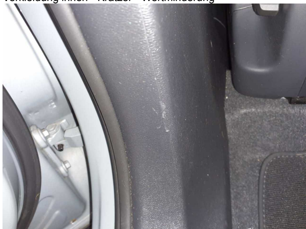
Beschädigung #3: Verkleidungen/Abdeckungen: B-Säule links Verkleidung innen - Kratzer - Wertminderung
