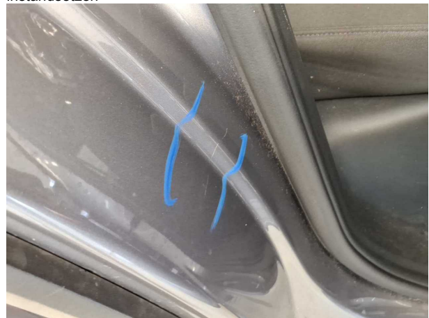
Beschädigung #3: Seitenwand rechts: Einstieg - verkratzt / verschürft - Smart Repair
