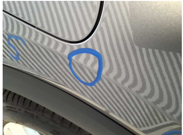
Beschädigung #6: Seitenwand rechts: Seitenwand - Delle / Lackschaden - instandsetzen und lackieren
