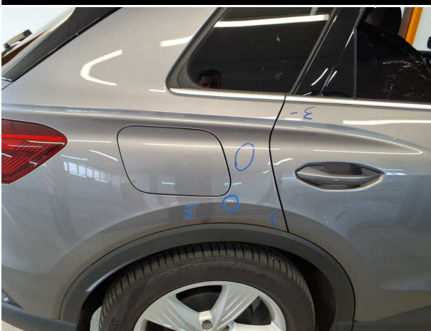
Beschädigung #6: Seitenwand rechts: Seitenwand - Delle / Lackschaden - instandsetzen und lackieren
