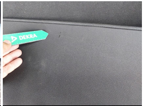
Elementos fallantes / Cubierta de carga
