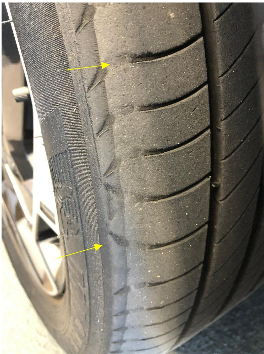
Bild 10 : Reifen vorne links einseitiger Verschleiß, Achsvermessung
