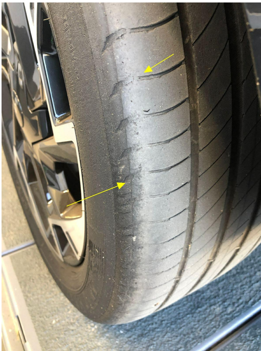
Bild 11 : Reifen hinten links einseitiger Verschleiß, Achsvermessung
