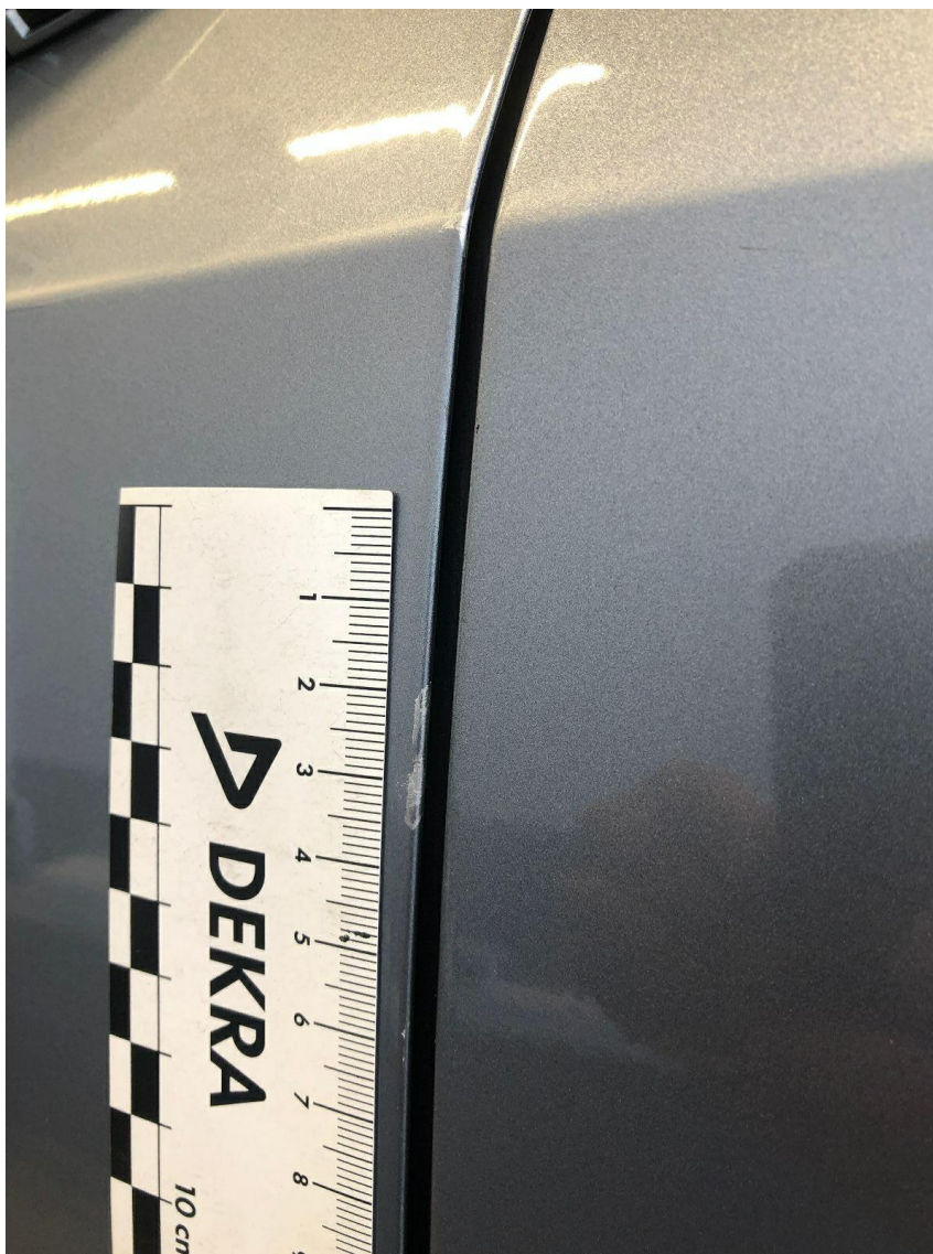
Bild 9 : Tür vorne links Türkante, verschrammt, smart repair
