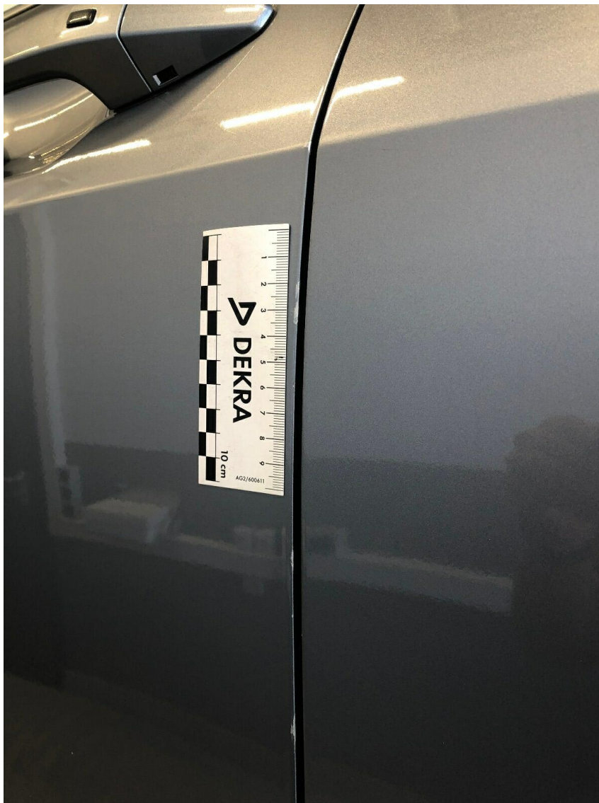
Bild 8 : Tür vorne links Türkante, verschrammt, smart repair
