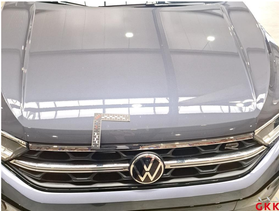
Bild 17 Motorhaube, Steinschlag, auslegen, schleifen, polieren
