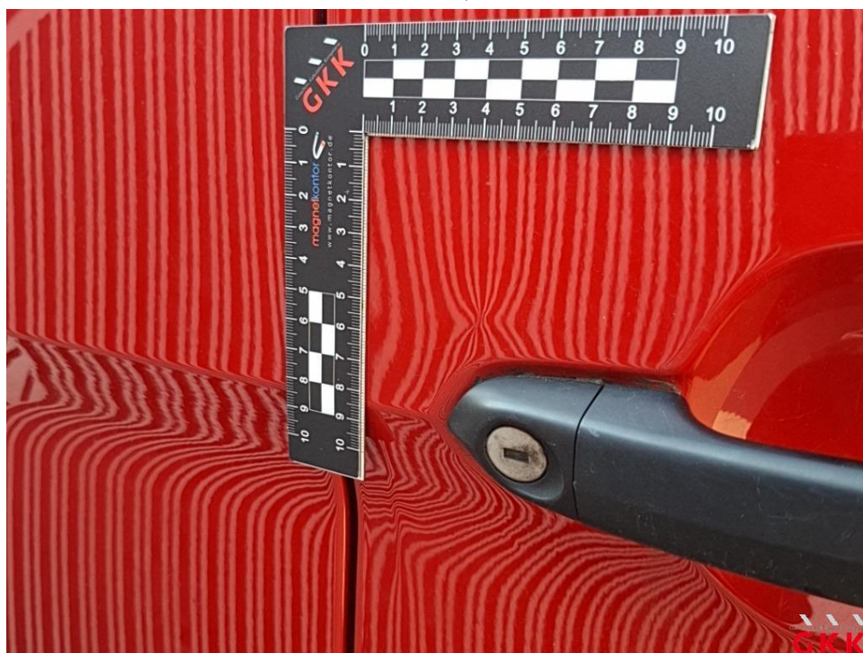
Bild 32. Hecktür rechts, bis 3 Dellen / Bauteil, Smartrepair
