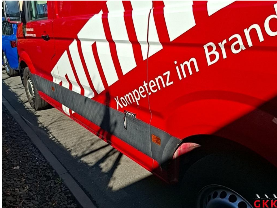
Bild 27. Seitenwand links, Leiste -unten-, verkratzt, ersetzen
