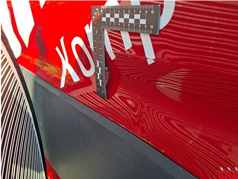
Bild 25. Seitenwand links, vorne, beschädigt, instand setzen - lackieren
