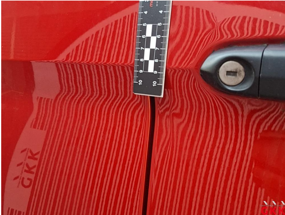
Bild 33. Hecktür rechts, bis 3 Dellen / Bauteil, Smartrepair
