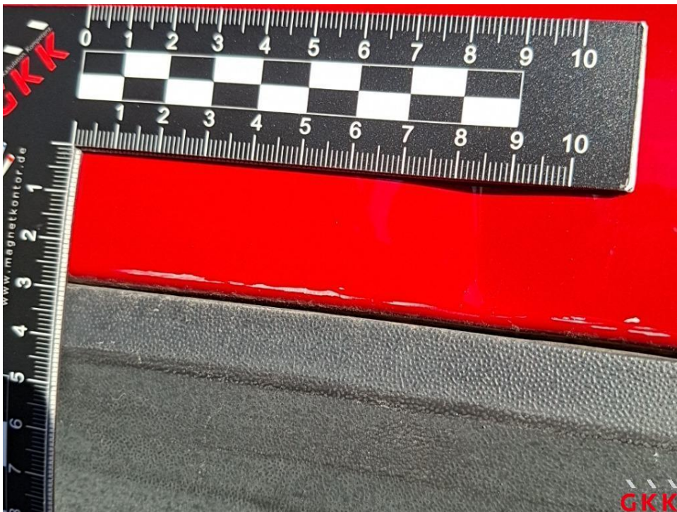
Bild 26. Seitenwand links, vorne, beschädigt, instand setzen - lackieren
