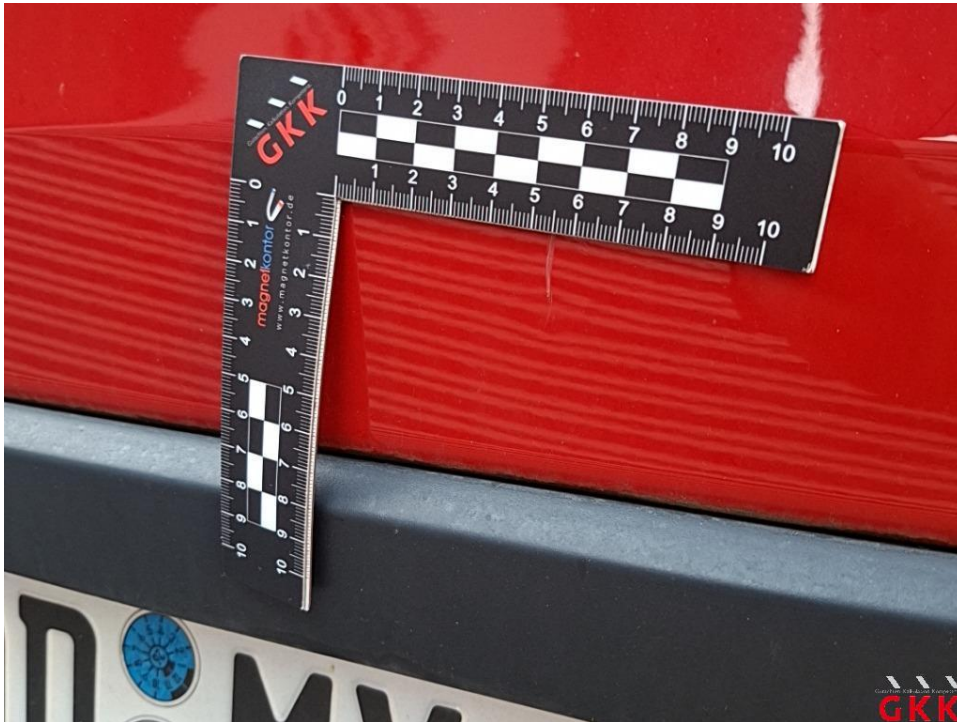
Bild 30. Hecktür links, bis 3 Dellen / Bauteil, Smartrepair
