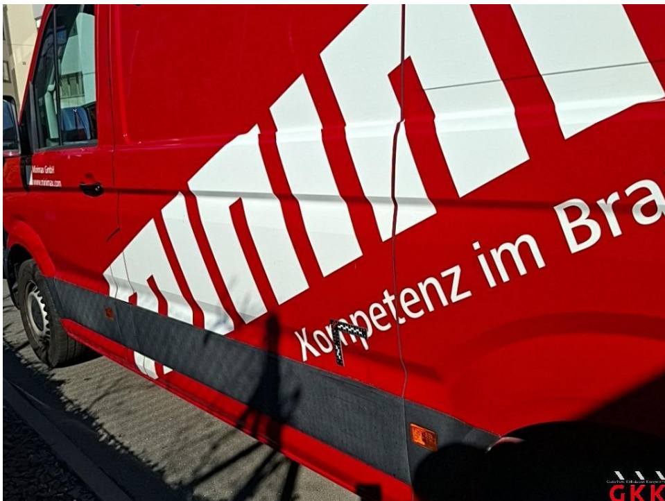
Bild 24. Seitenwand links, vorne, beschädigt, instand setzen - lackieren
