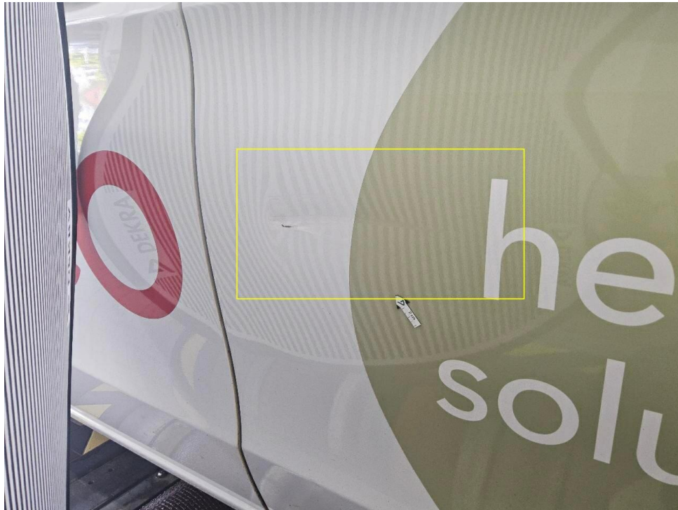
Bild 17 : Tür vorne rechts, eingedellt
