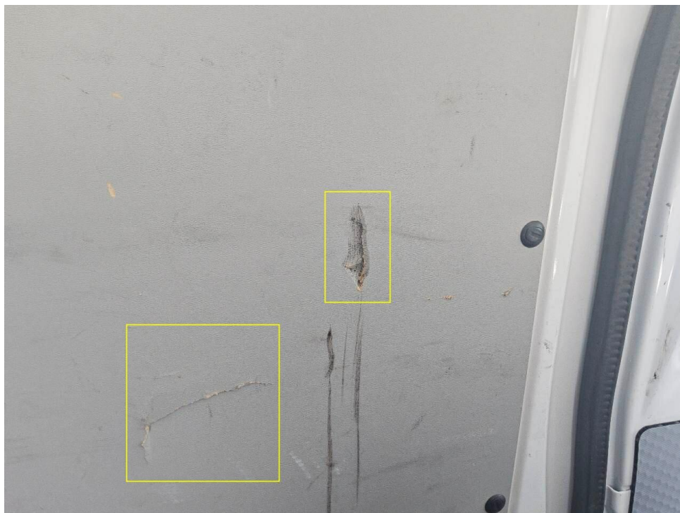
Bild 22 : Schiebetür rechts Verkleidung, gerissen
