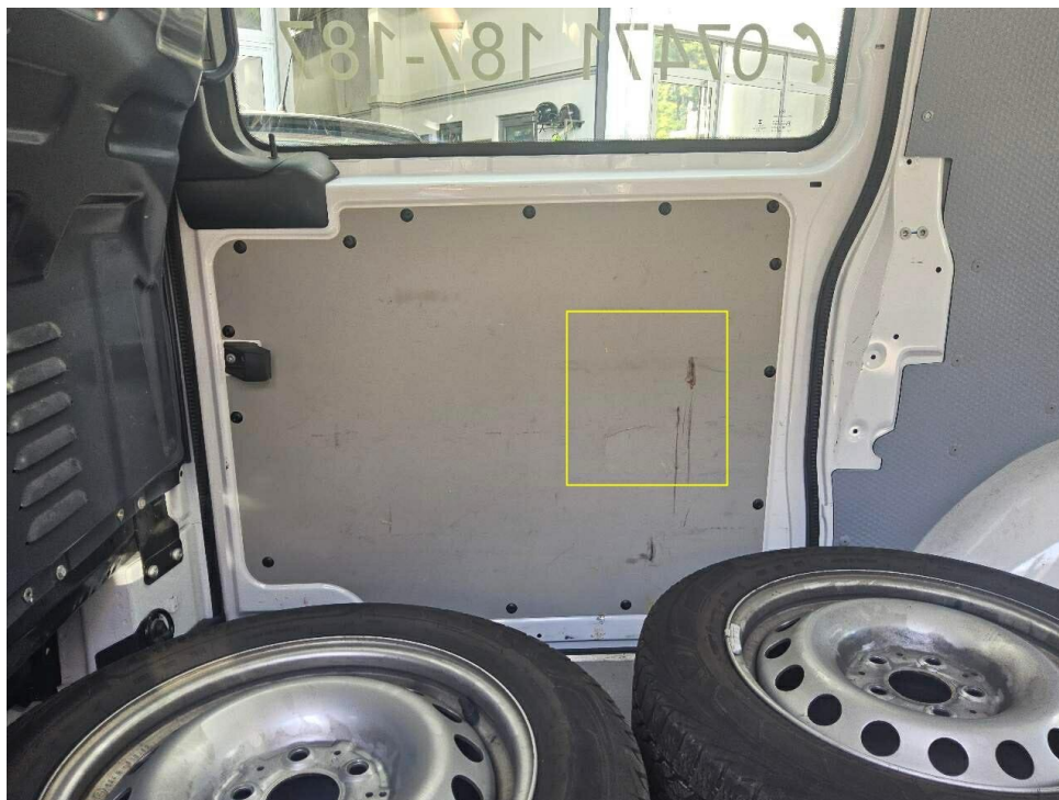
Bild 21 : Schiebetür rechts Verkleidung, gerissen
