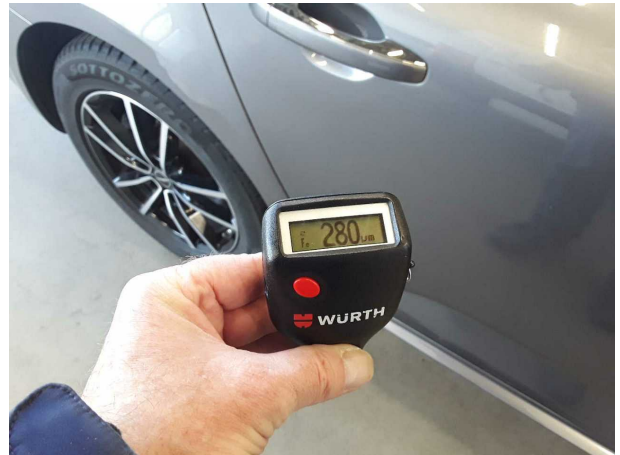
Nachlackierung 1: Seitenwand rechts, Tür hinten rechts
