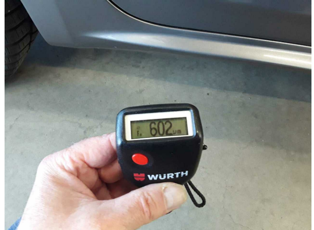
Nachlackierung 1: Seitenwand rechts, Tür hinten rechts
