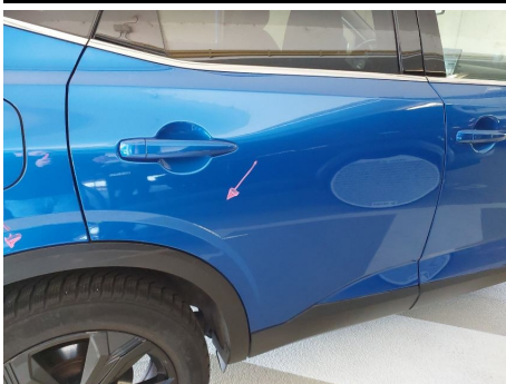
Tür / Hinten Rechts / Kratzer
