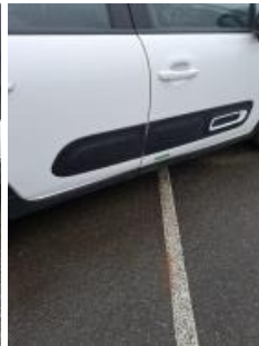
Garniture bas de caisse ext D, Déformé / Forcé, E - Remplacer
