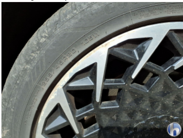
5. Felge Vorne - Rechts Kratzer - Smart Repair
