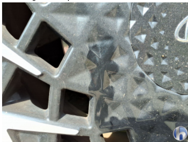
4. Felge Vorne - Rechts Kratzer - Smart Repair
