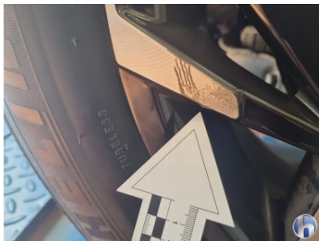
5. Felge Hinten - Rechts Kratzer - Smart Repair
