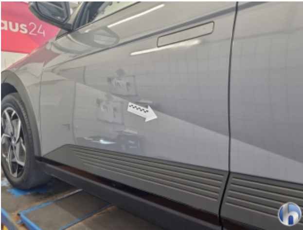
2. Tür Vorne - Links 1 Delle - Sanft Instandsetzen
