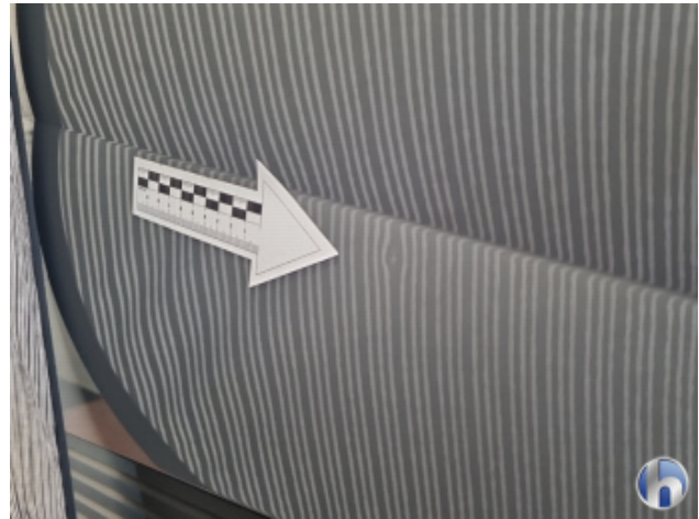
2. Tür Vorne - Links 1 Delle - Sanft Instandsetzen
