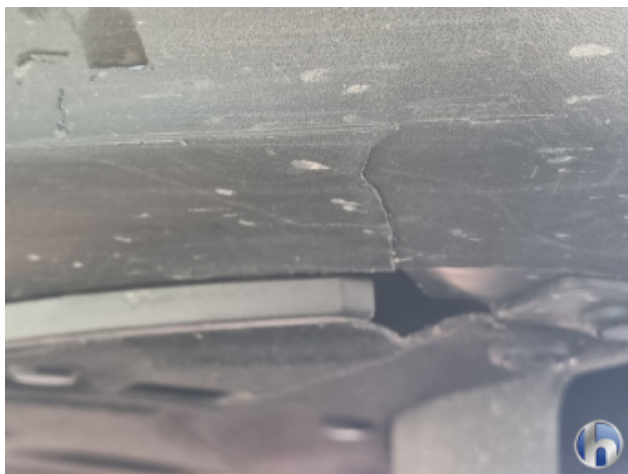
1. Stoßfänger Vorne Riss - Erneuern
