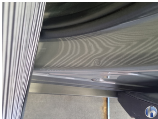
4. Einstiegsleiste Vorne - Links 2 Dellen - Sanft Instandsetzen
