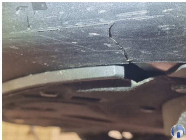
1. Stoßfänger Vorne Riss - Erneuern
