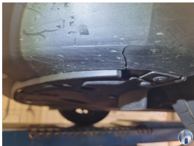
1. Stoßfänger Vorne Riss - Erneuern
