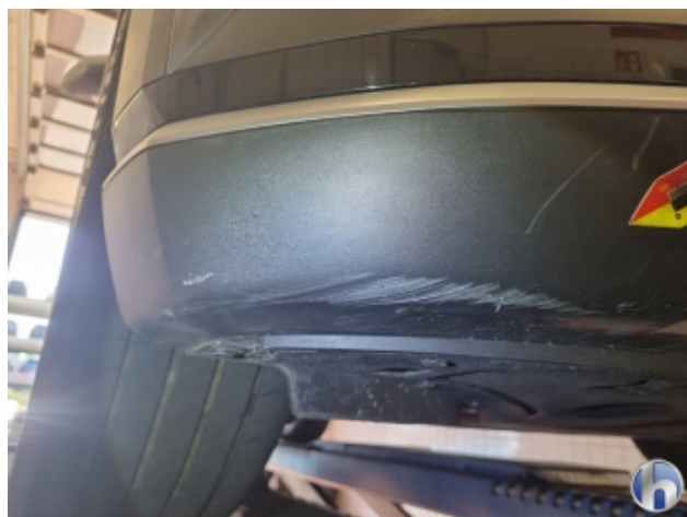
1. Stoßfänger Vorne Riss - Erneuern
