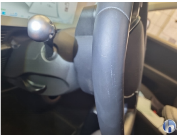
6. Lenkrad (leder) Kratzer - Smart Repair
