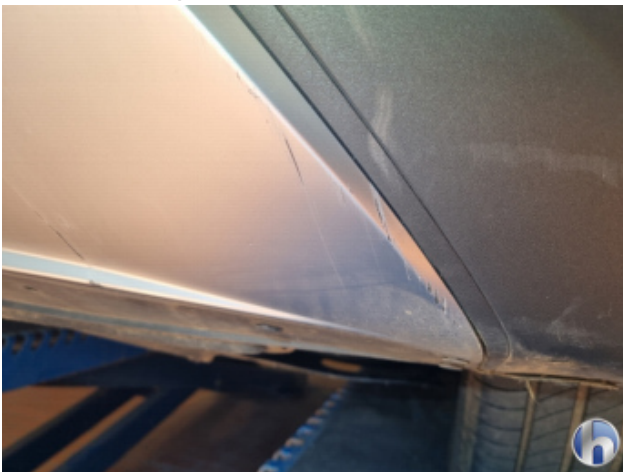
3. Stoßfänger Hinten Kratzer - Smart Repair
