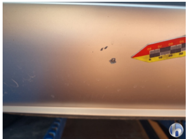
3. Stoßfänger Hinten Kratzer - Smart Repair
