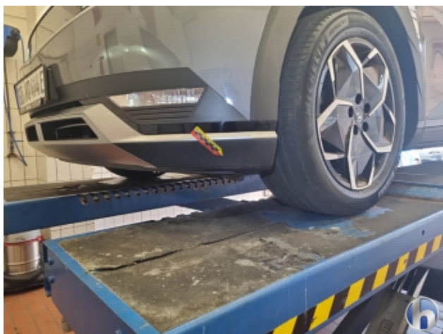
1. Stoßfänger Vorne Riss - Erneuern
