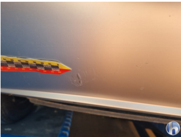
3. Stoßfänger Hinten Kratzer - Smart Repair
