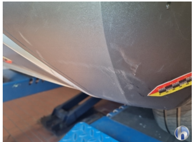
3. Stoßfänger Hinten Kratzer - Smart Repair
