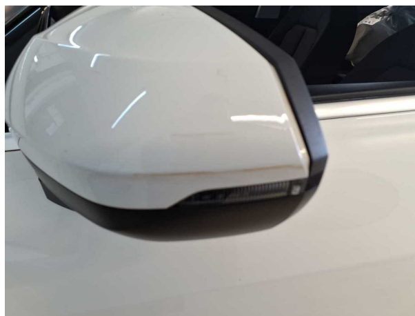
Beschädigung #6: Außenspiegel links: Abdeckkappe - verkratzt / verschürft - Smart Repair
