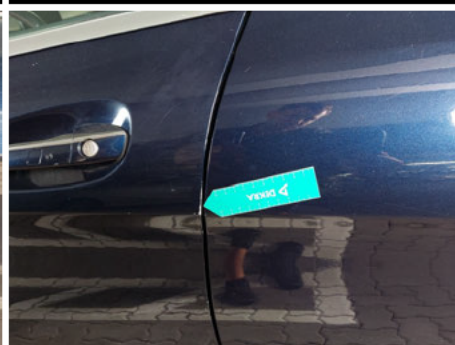
Tür / Vorne Links / Abgewetzt
