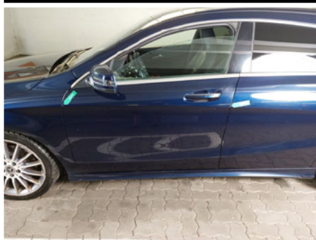
Tür / Vorne Links / Abgewetzt
