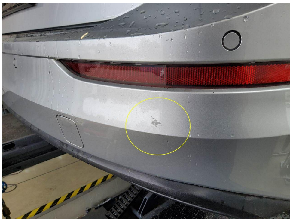
Bild 18 : Stoßfänger hinten rechts oberflächlich verschrammt.
