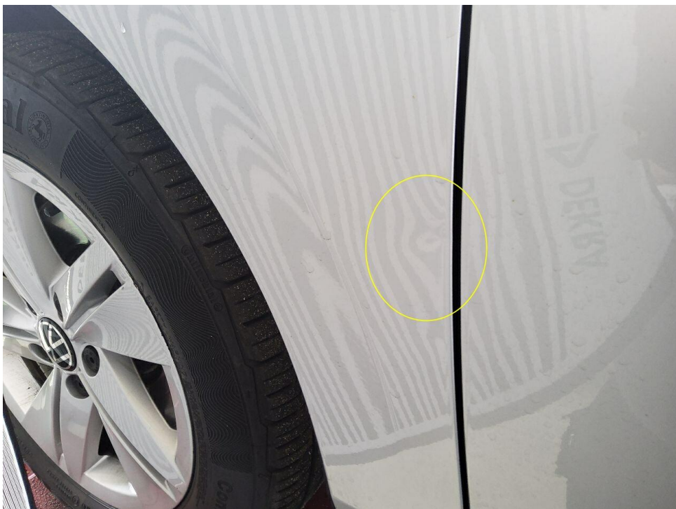
Bild 20 : Kotflügel vorne links eingedellt.
