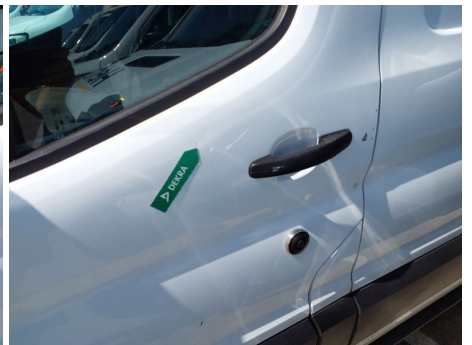
Puerta / Delantero Izquierdo / Abolladura
