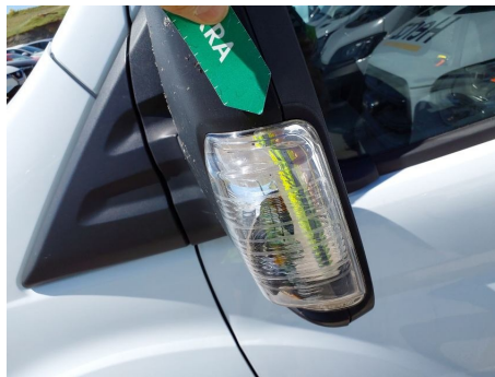
Piloto del intermitente / Izquierda / Roto
