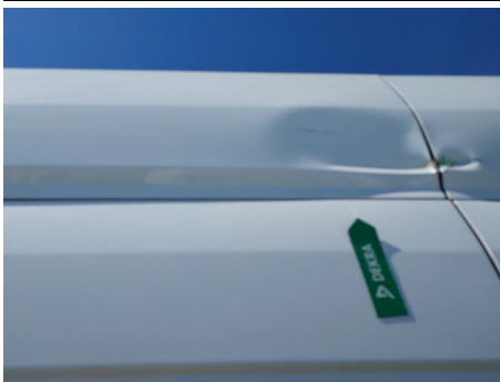
Panel lateral / Izquierda / Abolladura
