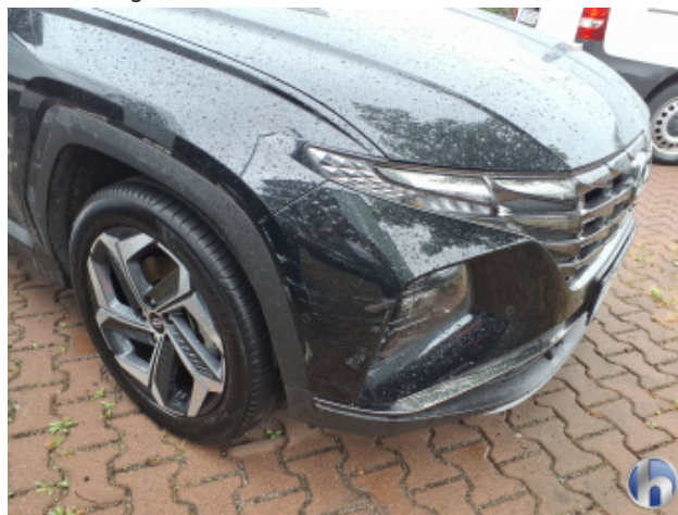
7. Stoßfänger Vorne Abschürfung - Lackieren
