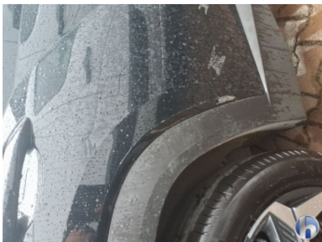
2. Tür Hinten - Rechts Kratzer - Lackieren
