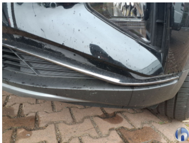
7. Stoßfänger Vorne Abschürfung - Lackieren
