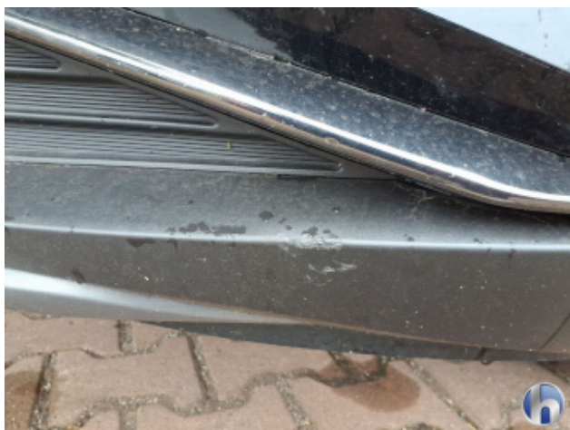
7. Stoßfänger Vorne Abschürfung - Lackieren
