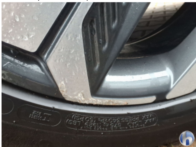
5. Felge Hinten - Rechts Kratzer - Smart Repair
