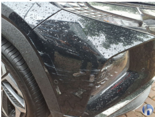
7. Stoßfänger Vorne Abschürfung - Lackieren
