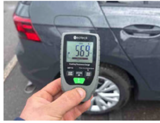
Lackstärke Seitenwand hinten rechts
