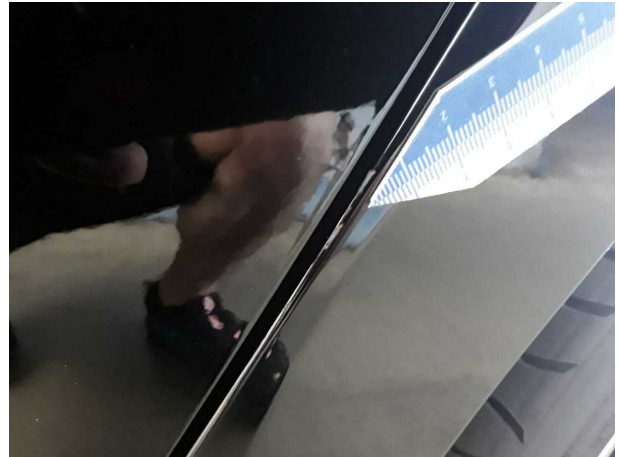
Beschädigung #1: Seitenwand links: Seitenwand - Kratzer - Smart Repair
