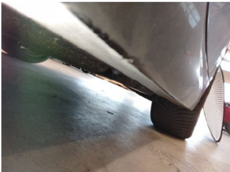
Schwellerverkleidung / Links / Kratzer
