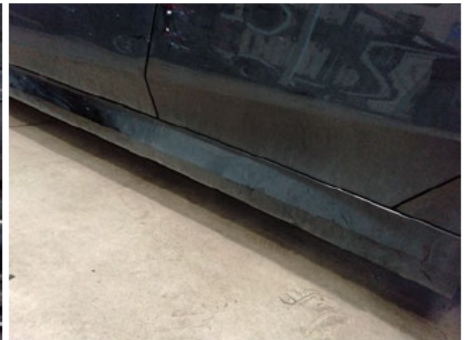
Schwellerverkleidung / Links / Kratzer
