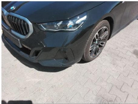
Stoßfängerleiste / Vorne Links / Kratzer
