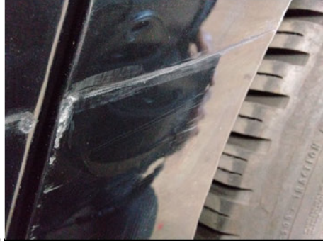
Kotflügel / Hinten Links / Schlecht Repariert
