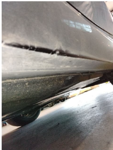
Schwellerverkleidung / Links / Kratzer
