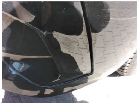
Stoßfängerleiste / Vorne Links / Kratzer
