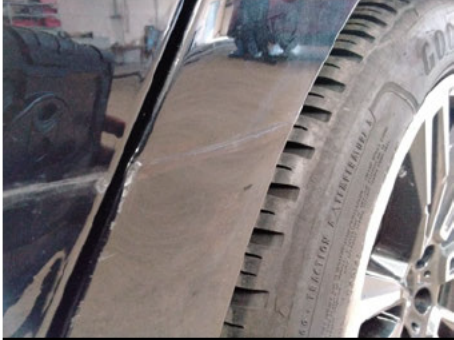
Kotflügel / Hinten Links / Schlecht Repariert
