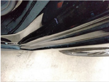
Kotflügel / Hinten Links / Schlecht Repariert
