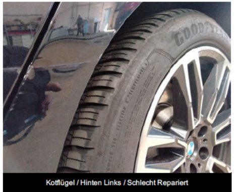
Kotflügel / Hinten Links / Schlecht Repariert
