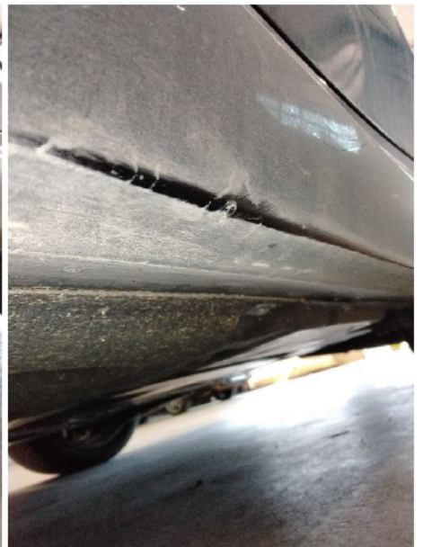
Schwellerverkleidung / Links / Kratzer
