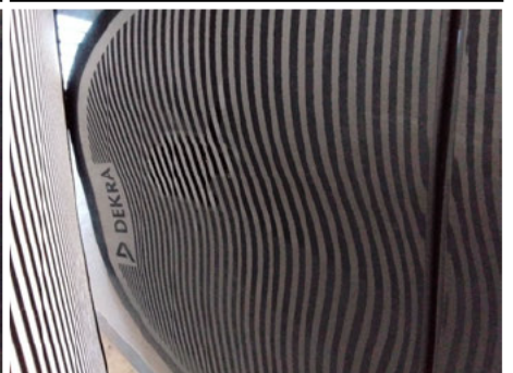
Tür / Vorne Rechts / Delle
