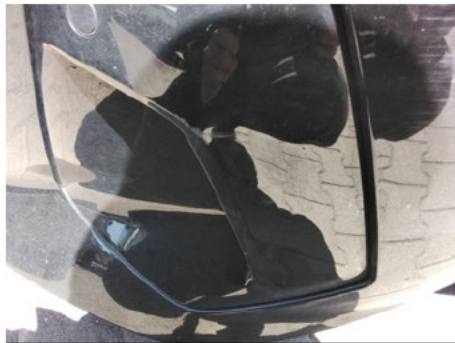
Stoßfängerleiste / Vorne Links / Kratzer
