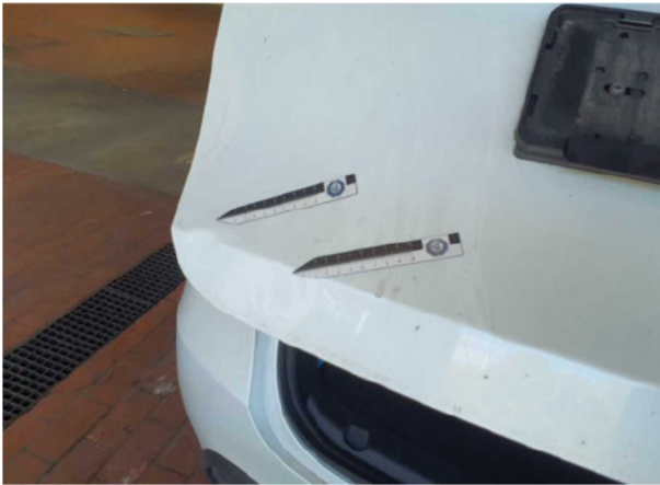
Beschädigung #3: Heckklappe/-tür: Heckklappe - Delle(n) - sanft instandsetzen
