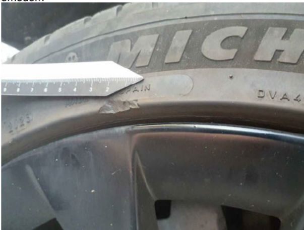
Beschädigung #4: Rad/Reifen: Reifen hinten rechts - beschädigt - erneuern
