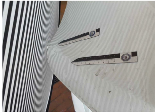
Beschädigung #3: Heckklappe/-tür: Heckklappe - Delle(n) - sanft instandsetzen
