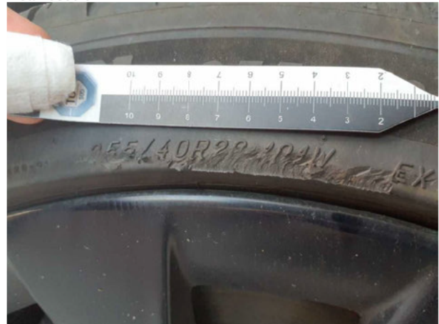
Beschädigung #4: Rad/Reifen: Reifen hinten rechts - beschädigt - erneuern
