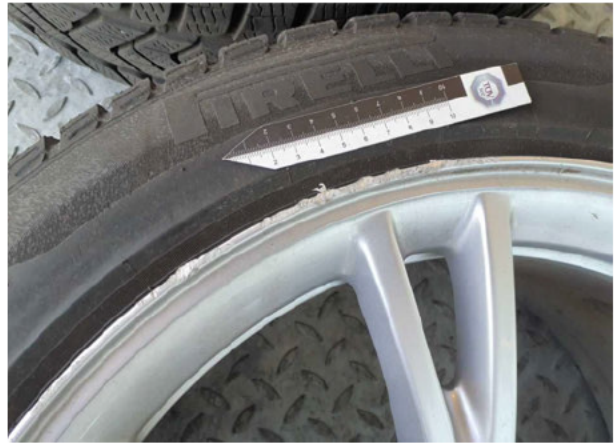
Beschädigung #5: Rad/Reifen: Leichtmetallfelge vorn rechts (Winterradsatz) - beschädigt - erneuern
