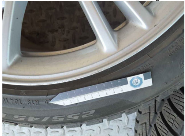
Beschädigung #2: Rad/Reifen: Leichtmetallfelge hinten rechts (Winterradsatz) - verkratzt / verschürft - Wertminderung
