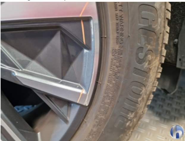
5. Felge Hinten - Rechts Beschädigt - Smart Repair
