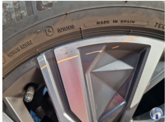
5. Felge Hinten - Rechts Beschädigt - Smart Repair
