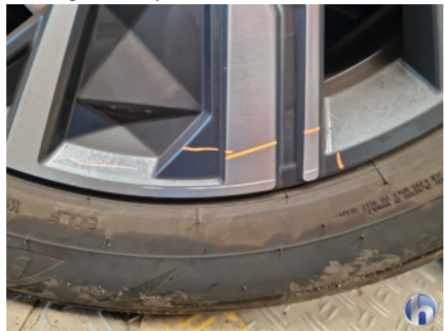
5. Felge Hinten - Rechts Beschädigt - Smart Repair
