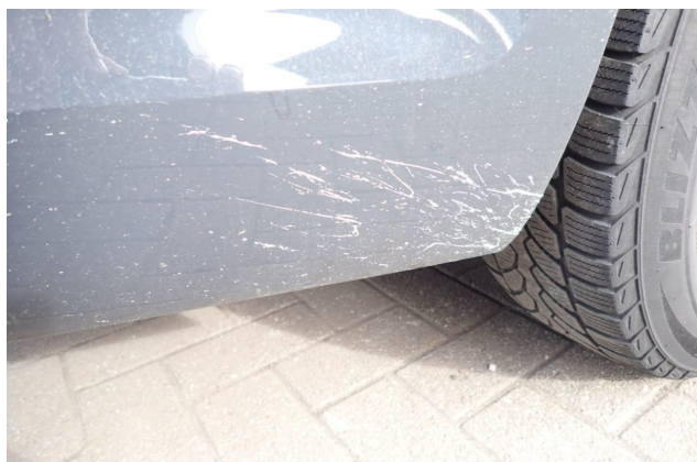
Beschädigung 2: Stossfänger hinten: Stossfänger hinten - verschmutzt - reinigen
