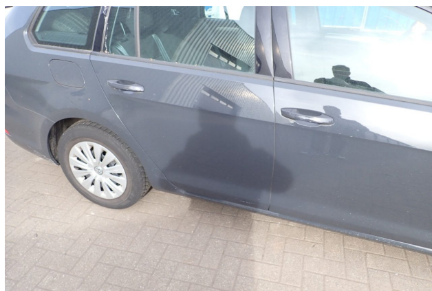
Gebrauchsspur 4: Heckklappe/-tür: Hecktür rechts - Delle(n) - Smart Repair
