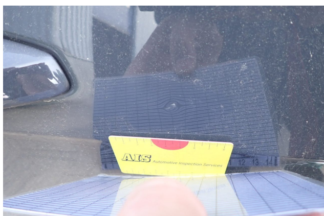
Gebrauchsspur 4: Heckklappe/-tür: Hecktür rechts - Delle(n) - Smart Repair
