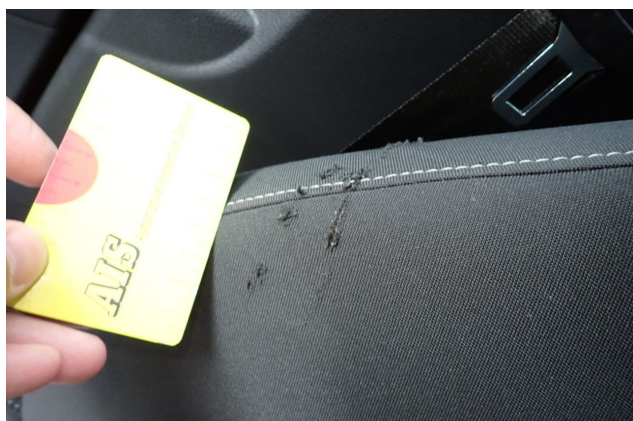
Beschädigung 10: Sitz vorn: Sitzbezug rechts - gebrochen / gerissen - erneuern
