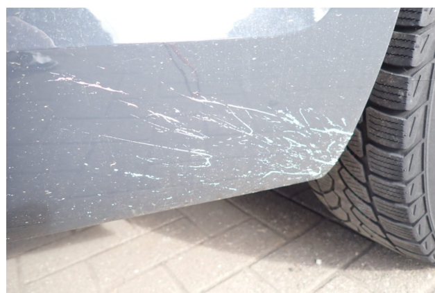
Beschädigung 2: Stossfänger hinten: Stossfänger hinten - verschmutzt - reinigen
