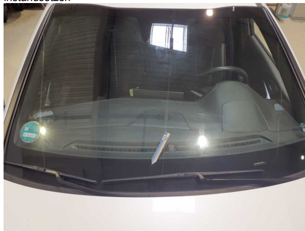
Beschädigung #3: Verglasung: Frontscheibe (Mit Rissbildung) - Steinschlag - erneuern
