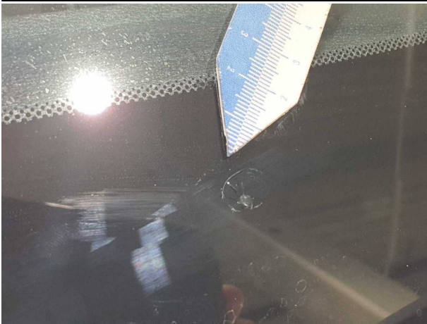
Beschädigung #3: Verglasung: Frontscheibe (Mit Rissbildung) - Steinschlag - erneuern
