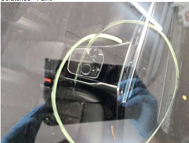
Damage #6: Vehicle glazing: Windscreen with rain sensor (Mit Rissbildung) - Stone chips - Replace
