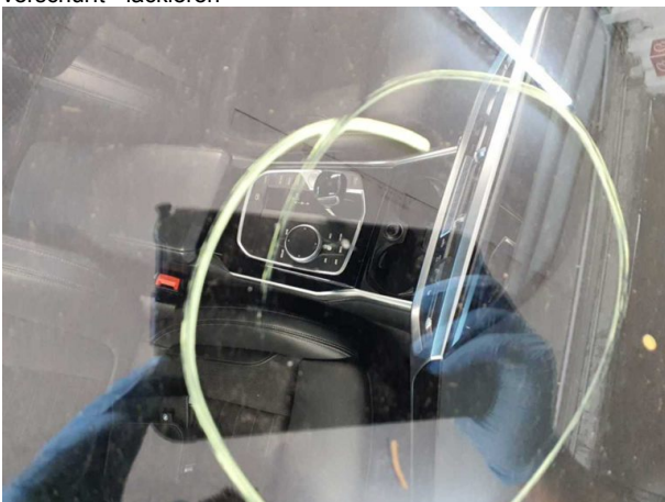
Beschädigung #6: Verglasung: Frontscheibe mit Regensensor (... Rissbildung) - Steinschlag - erneuern
