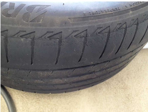
Beschädigung #3: 2.Radsatz: 2 Reifen - verschlissen - erneuern
