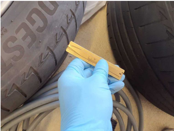
Beschädigung #3: 2.Radsatz: 2 Reifen - verschlissen - erneuern
