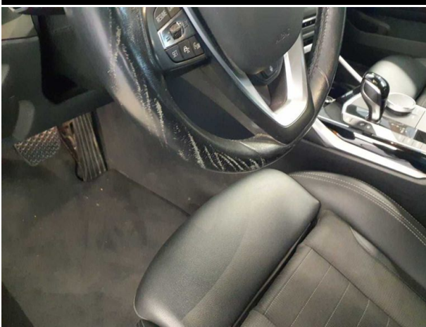
Beschädigung #4: Lenkanlage: Lenkrad - verkratzt / verschürft - erneuern
