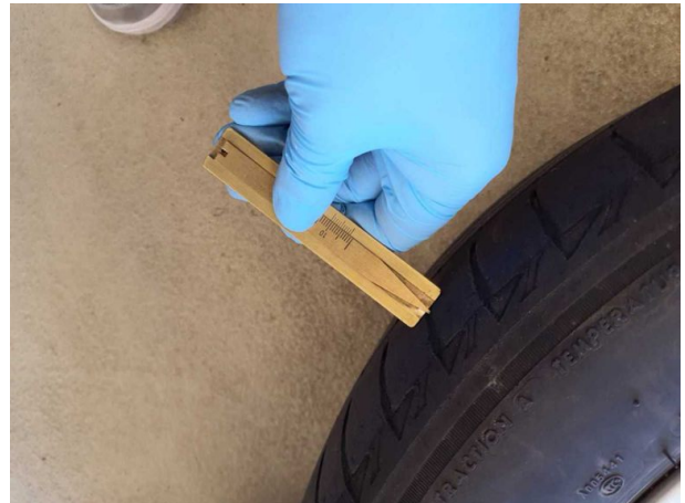
Beschädigung #3: 2.Radsatz: 2 Reifen - verschlissen - erneuern
