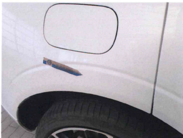
Beschädigung #1: Seitenwand rechts: Seitenwand - Delle(n) - sanft instandsetzen
