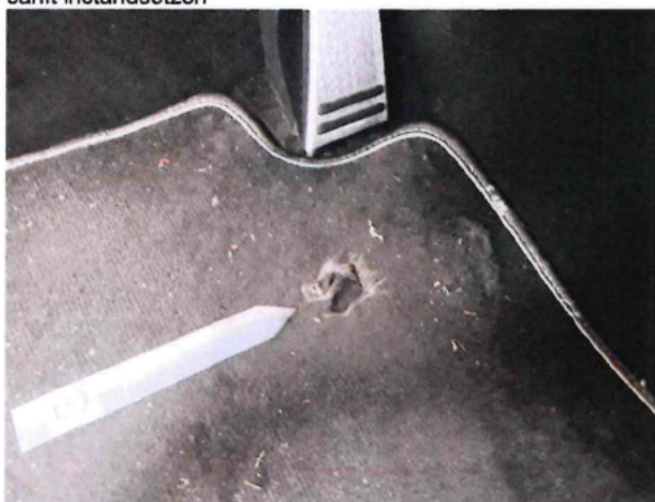
Beschädigung #2: Verkleidungen/Abdeckungen: Fußmatten - Löcher - erneuern
