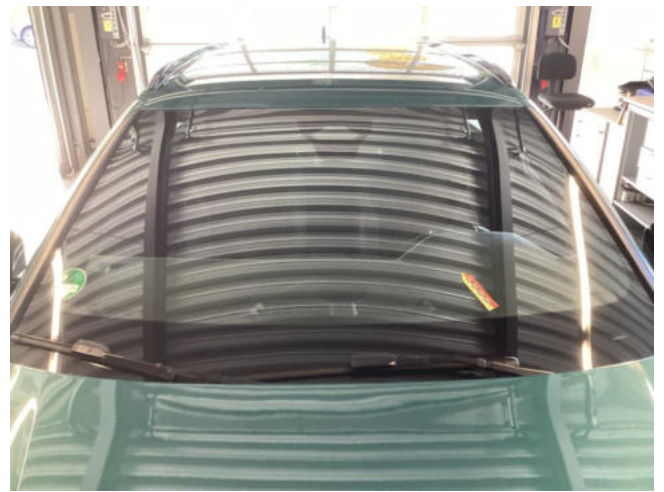
Windschutzscheibe - Steinschlag im Fahrersichtfeld - erneuern
