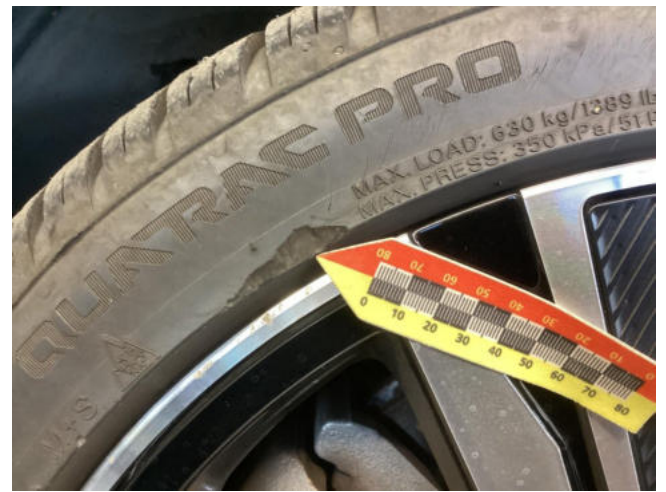
Reifen VL - Flanke beschädigt - erneuern
