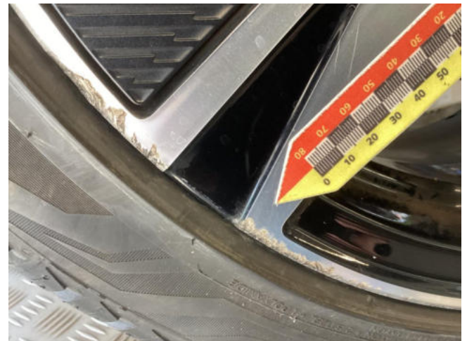
Felge HR - zerkratzt mit Materialabtrag - erneuern
