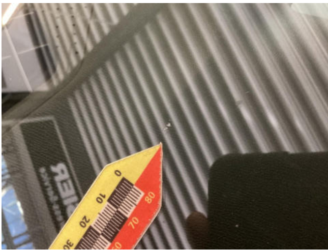
Windschutzscheibe - Steinschlag im Fahrersichtfeld - erneuern
