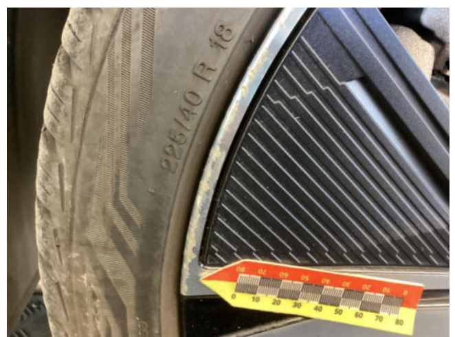
Felge VL - zerkratzt mit Materialabtrag - erneuern
