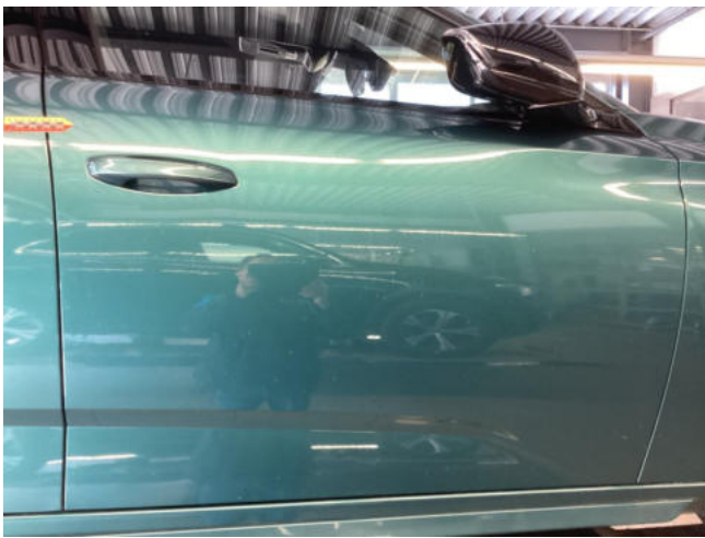
Tür vorne rechts - verdellt / verkratzt - instandsetzen und lackieren
