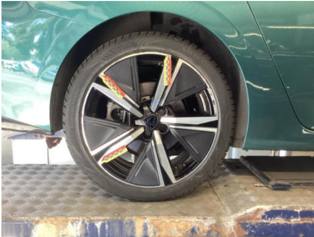
Felge HR - zerkratzt mit Materialabtrag - erneuern
