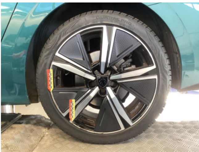
Felge HL - zerkratzt mit Materialabtrag - erneuern
