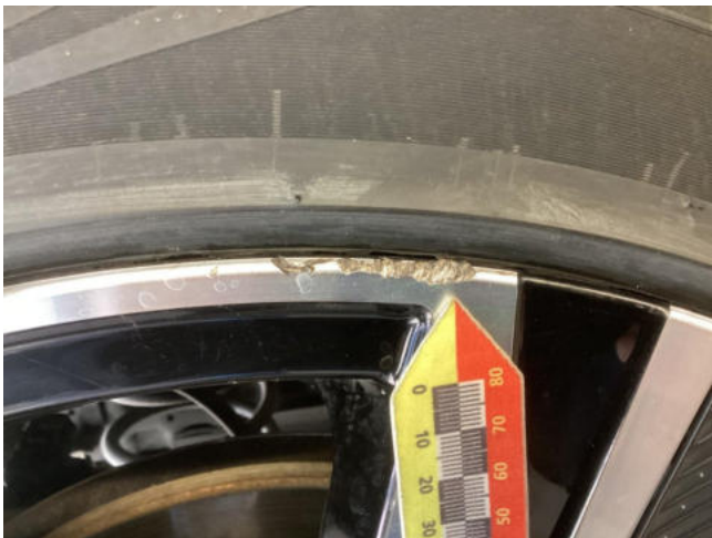
Felge HR - zerkratzt mit Materialabtrag - erneuern
