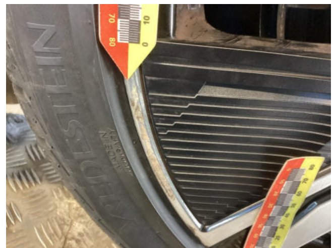
Felge HL - zerkratzt mit Materialabtrag - erneuern
