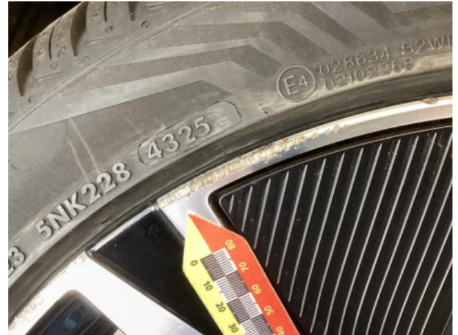
Felge HR - zerkratzt mit Materialabtrag - erneuern
