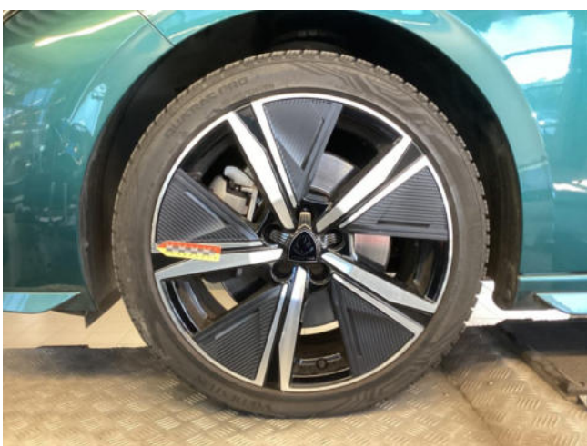
Felge VL - zerkratzt mit Materialabtrag - erneuern
