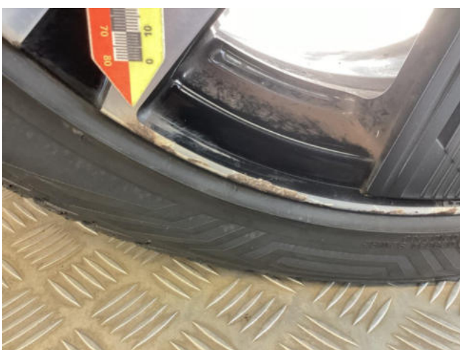
Felge HL - zerkratzt mit Materialabtrag - erneuern
