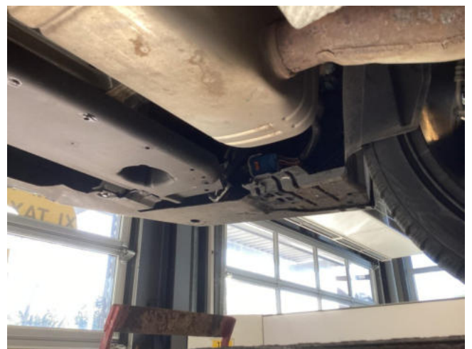
Kabelbaum HL - lose - befestigen
